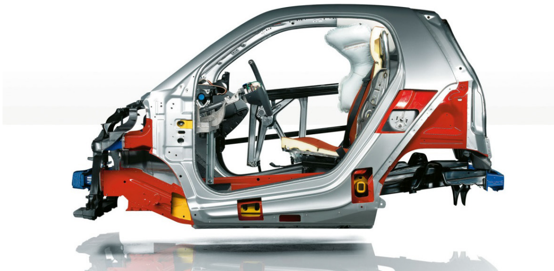
Εικόνα 1.19: Πλαίσιο και κλωβός ασφαλείας Smart Fortwo του 1998.
