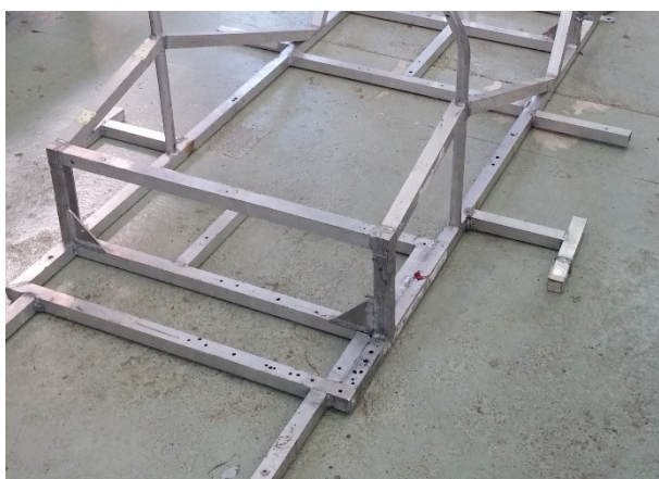
Εικόνα 2.12: Πλαίσιο ER2014. Εμφανή είναι τα σημάδια φθοράς και οι οπές στήριξης.
