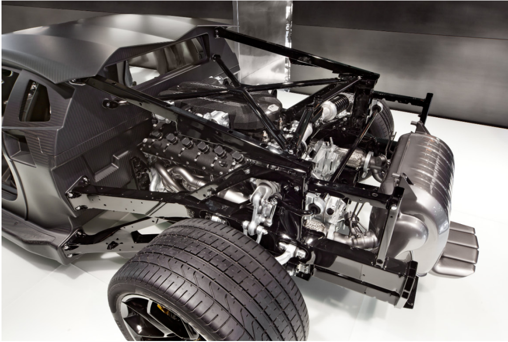
Εικόνα 1.16: Πίσω μεταλλικό υποπλάνιο κινητήρα. Lamborghini Aventador LP 700-4 του 2015.
