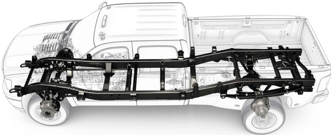
Εικόνα 1.4: Σασί τύπου σκάλας του οχήματος GMC Sierra.
