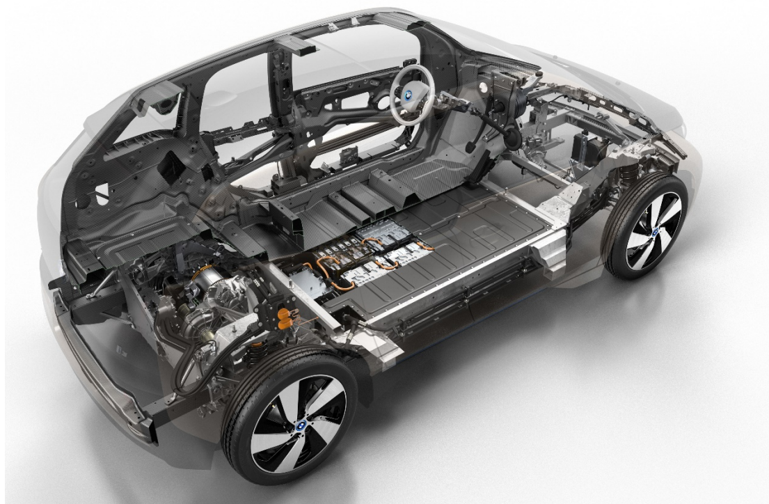
Εικόνα 1.20 Εσωτερική τομή BMW i3. Εμφανή είναι το πλαίσιο και ο ηλεκτροκινητήρας του οχήματος.
