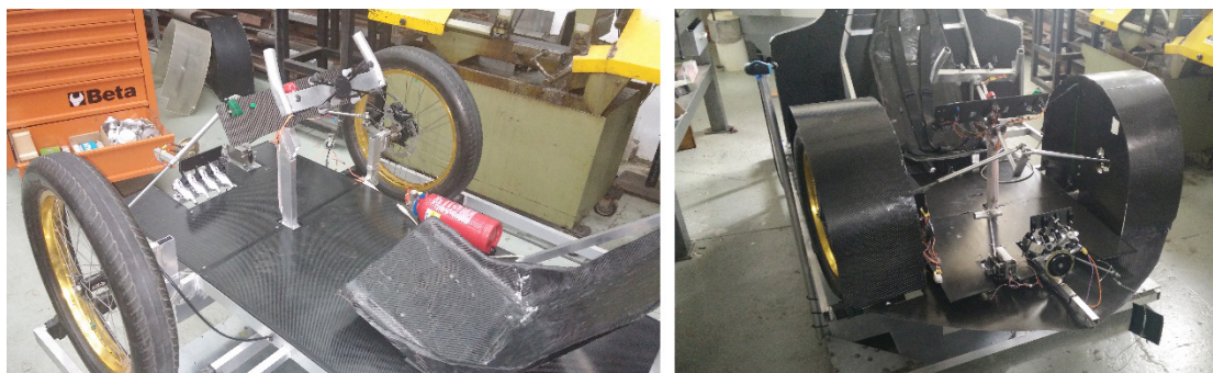
Εικόνα 5.8: Τοποθέτηση πατωμάτων και τμημάτων καμπίνας.
