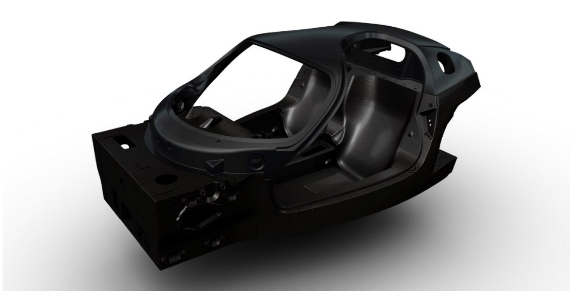
Εικόνα 1.14: Αυτοφερόμενο σασί από ανθρακονήματα. Ferrari La Ferrari του 2013.
