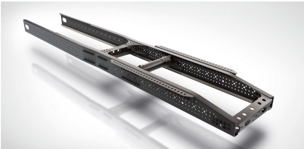
Εικόνα 1.5: Σασί σειράς φορτηγών Mercedes – Benz Actros. Χαρακτηριστικό παράδειγμα σασί τύπου σκάλας που προσαρμόζεται σε παραπάνω από έναν τύπους οχημάτων.
