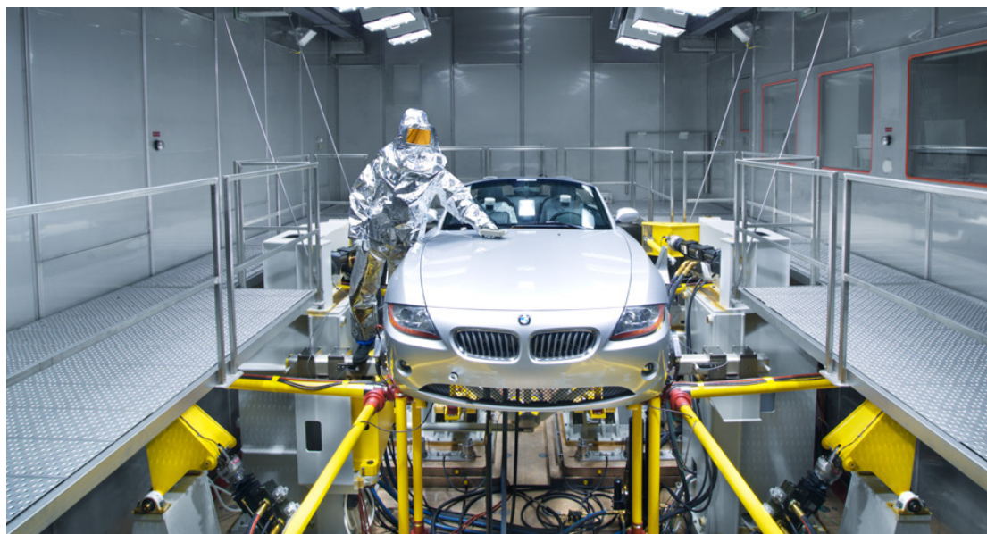
Εικόνα 3.16: Πειραματική ανάλυση δονήσεων σε BMW Z4 του 2006.
