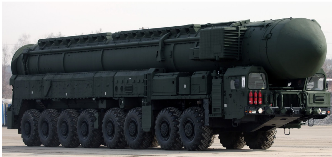
Εικόνα 1.6: Στρατιωτικό φορτηγό MAZ 79221. Το όχημα φέρει σασί τύπου σκάλας.
