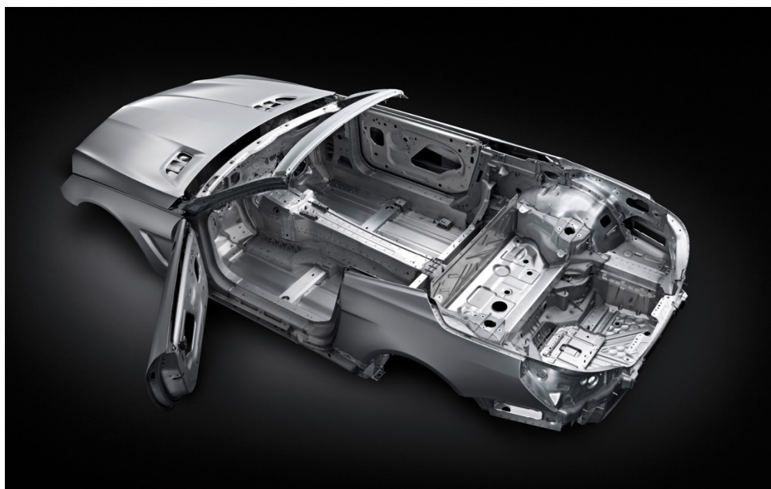
Εικόνα 1.15: Αυτοφερόμενο σασί αλουμινίου. Mercedes – Benz SL550 του 2016.
