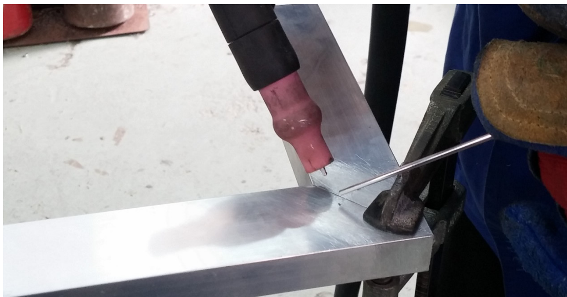
Εικόνα 5.3: Συγκόλληση του πλαισίου με τη μέθοδο T.I.G.
