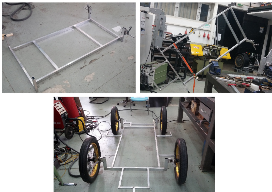
Εικόνα 5.5: Βασικό τμήμα πλαισίου υπό κατασκευή.
