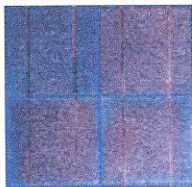
ΣΧΗΜΑ 4: ΤΥΠΙΚΟ ΦΩΤΟΒΟΛΤΑΪΚΟ ΣΤΟΙΧΕΙΟ ΤΑΙΝΙΑΣ ΠΥΡΙΤΙΟΥ
