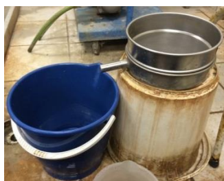
Εικόνα 5.1 Πραγματοποίηση της υγρής κοσκίνισης
