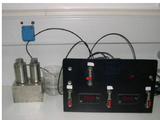
Εικόνα 4.1 Ποροσίμετρο και πειραματική διάταξη τύπου Boyle (από Γαμβρούδης, 2010 και Βαρότσης, 2014)
