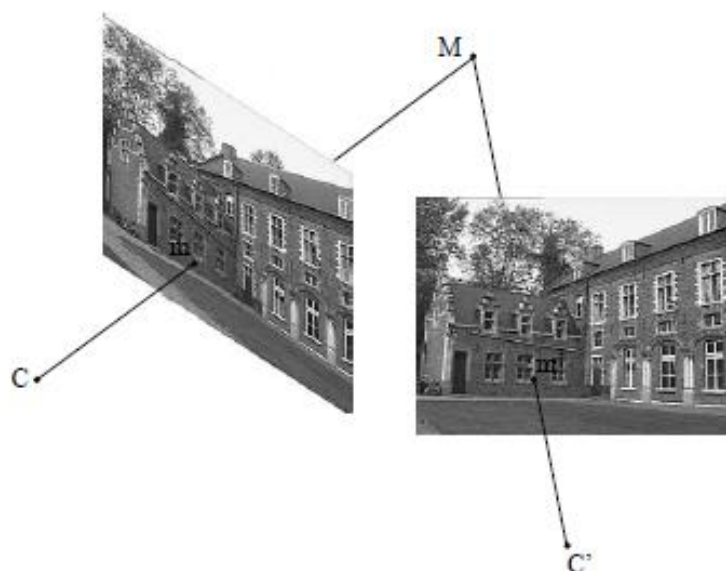
Εικόνα 2.3 Ανακατασκευή ενός τρισδιάστατου σημείου με τριγωνισμό. Πηγή : Marc Pollefeys, 'Visual 3D Modeling from Images'
