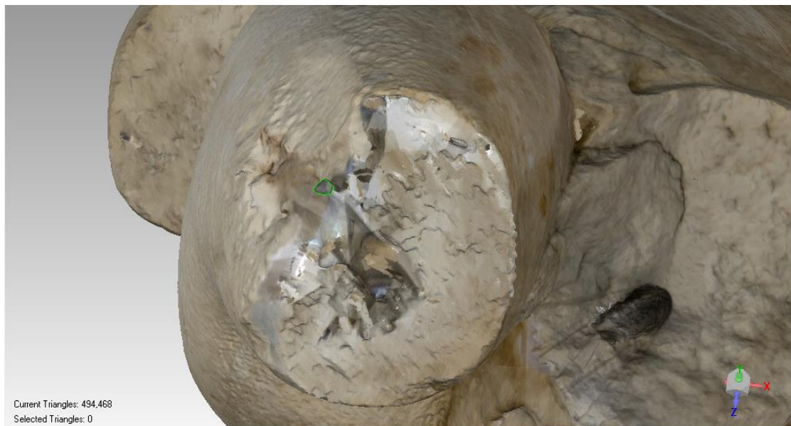
Εικόνα 4.2 Σε πράσινο πλαίσιο, διακρίνεται μια οπή η οποία δημιουργεί κενά στο πολυγωνικό μοντέλο
