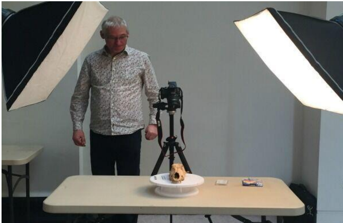
Εικόνα 3.7 3Δ αποτύπωση αντικειμένου σε περιστροφικό τραπέζι
