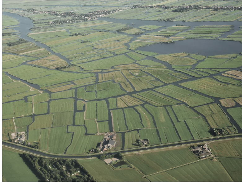
31. Κατασκευή των polders (υδρολογικές μονάδες) σε βαλτώδεις περιοχές για δημιουργία εδαφών προς κτηνοτροφία και για οικιστικές επεκτάσεις.
