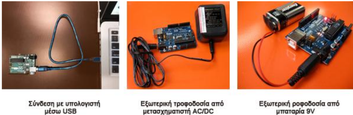
Σχήμα 2.23: Τρόποι τροφοδοσίας του Arduino
