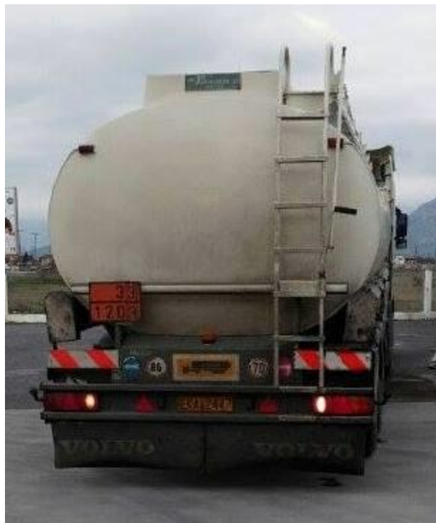
Εικόνα 2: Βυτιοφόρο όχημα, διακρίνεται ο προφυλακτήρας βαρέως τύπου.
