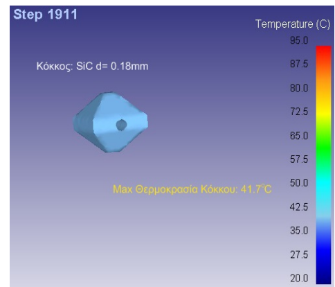
Σχήμα 4.46: Προσομοίωση λείανσης κόκκου SiC διαμέτρου 0.18mm με τεμάχιο DIN-16MnCr5 βάθους κοπής 10 \mu\text{m} και κατανομής θερμοκρασίας στον κόκκο μετά από μήκος διαδρομής 1000 \mu\text{m}
