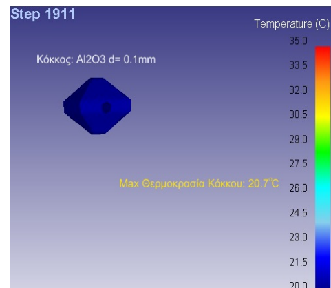
Σχήμα 4.38: Προσομοίωση λείανσης κόκκου Al_2O_3 διαμέτρου 0.1mm με τεμάχιο Aluminum 7075 βάθους κοπής 10μm και κατανομής θερμοκρασίας στον κόκκο μετά από μήκος διαδρομής 1000μm
