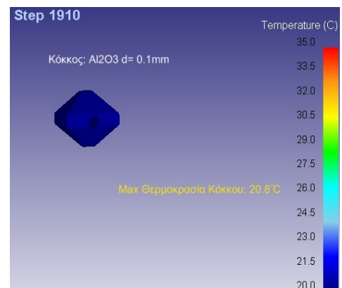
Σχήμα 4.26: Προσομοίωση λείανσης κόκκου \text{Al}_2\text{O}_3 διαμέτρου 0.1mm με τεμάχιο DIN-16MnCr5 βάθους κοπής 5 \mu\text{m} και κατανομής θερμοκρασίας στον κόκκο μετά από μήκος διαδρομής 1000 \mu\text{m}
