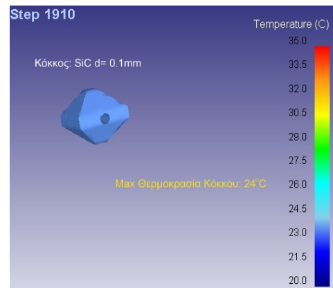
Σχήμα 4.37: Προσομοίωση λείανσης κόκκου SiC διαμέτρου 0.1mm με τεμάχιο Aluminum 7075 βάθους κοπής 10μm και κατανομής θερμοκρασίας στον κόκκο μετά από μήκος διαδρομής 1000μm
