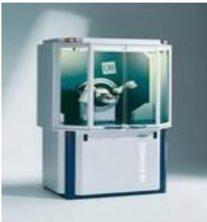
Εικόνα 3.3 Περιθλασίμετρο ακτίνων –Χ εργαστηρίου ορυκτολογίας.
