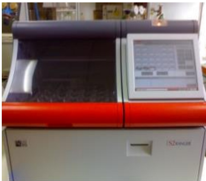
Εικόνα 3.4 Φασματοσκόπιο ακτίνων-Χ φθορισμού εργαστηρίου γεωχημείας.
