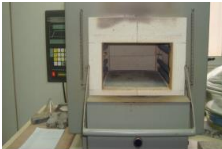
Εικόνα 3.5 Κλίβανος έψησης εργαστηρίου Πετρολογίας.
