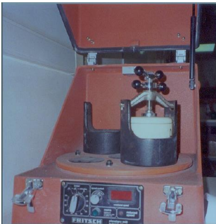
Σχήμα 3.2: Πλανητικός σφαιρόμυλος εργαστηρίου εμπλουτισμού.
