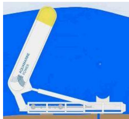
Εικόνα 7: Oyster, έως και το έτος 2010 είχε σχεδιαστεί μοντέλο που έχει ονομαστική ισχύ 2,5MW[36].
