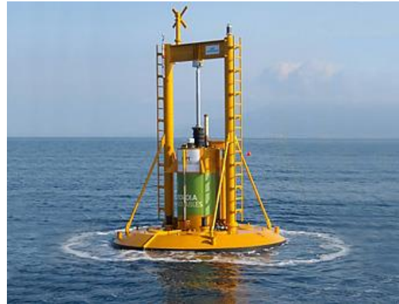
Εικόνα 9: Σημειακός απορροφητής, Powerbuoy ή OPT [38]
