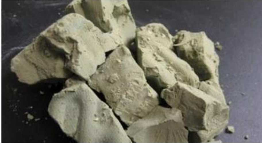
Εικόνα 4.22: Λάσπη ημιαγωγικού υλικού κατά την ανακύκλωση της First Solar.
