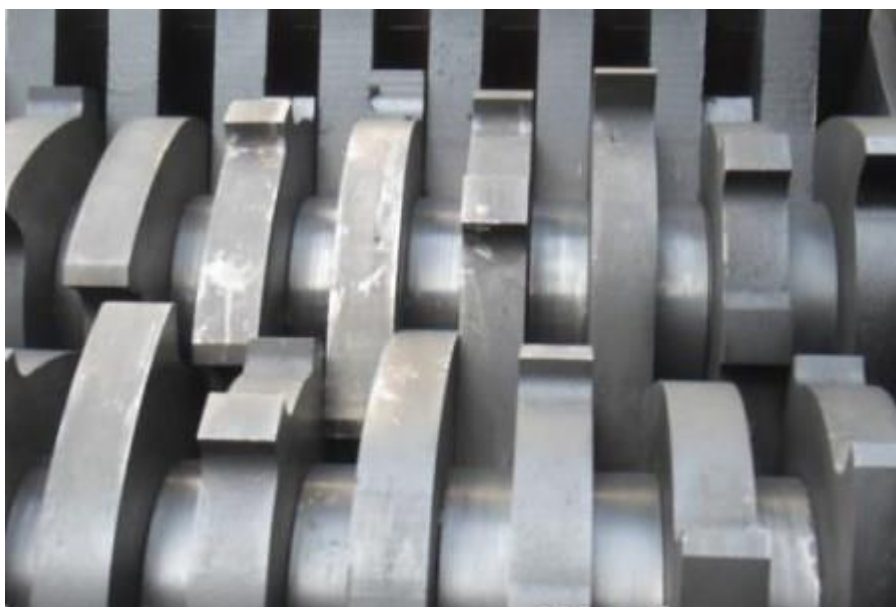
Εικόνα 8.17: Οι λεπίδες-μαχαίρια τεμαχισμού του μηχανήματος.
