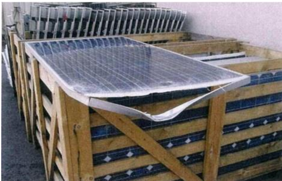
Εικόνα 4.6: Ελαττωματικά πλαίσια για ανακύκλωση.
