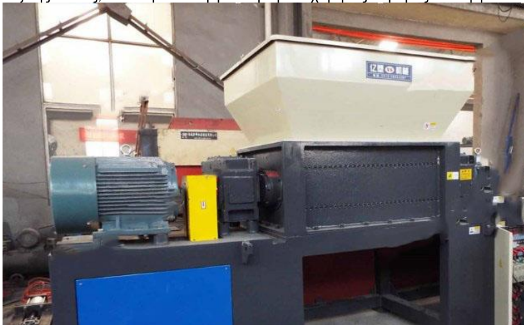
Εικόνα 8.16 Το μηχάνημα τεμαχισμού (Shredding Machine).
