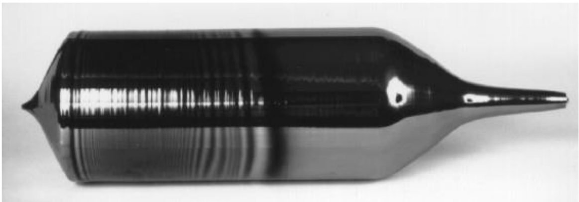
Εικόνα 3.4: Ράβδος καθαρού μονοκρυσταλλικού πυριτίου.
