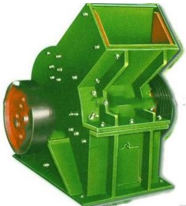
Εικόνα 8.18: Ο σφυρόμυλος (hammer milling).
