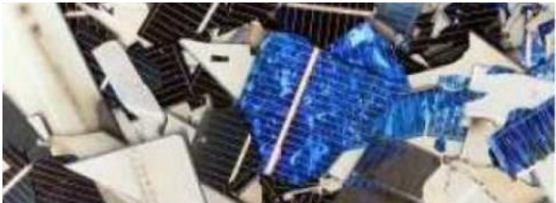
Εικόνα 4.13: Ηλιακές κυψέλες σπασμένες.
