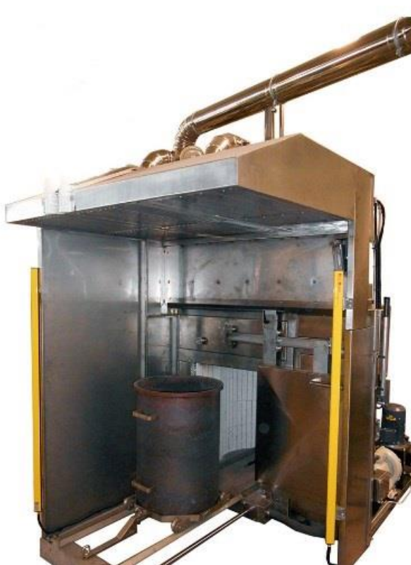
Εικόνα 8.19: Θερμική κατεργασία σε φούρνο πυρόλυσης (thermal treatment).
