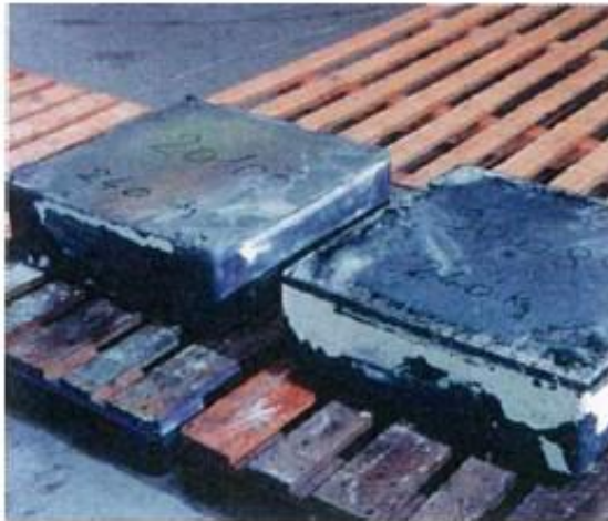
Εικόνα 3.8: Μπάρα πολυκρυσταλλικού πυριτίου.
