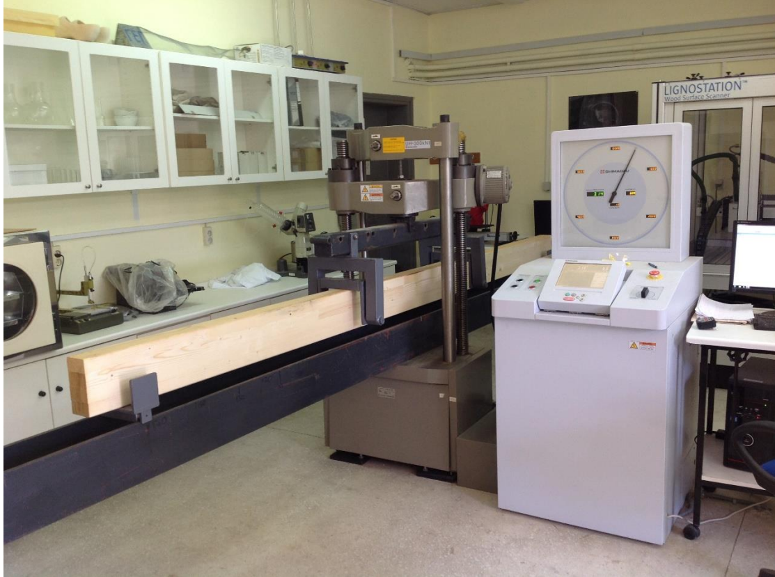
Εικόνα 29.1: Δοκιμή αντοχής σε κάμψη επικολλητής δοκού
