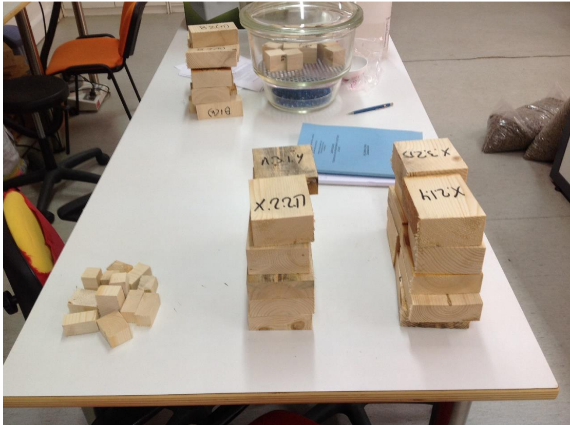
Εικόνα 22: Δειγματοληψία δοκιμίων για τον προσδιορισμό της εκλυόμενης φορμαλδεΐδης, πυκνότητας, υγρασίας.
