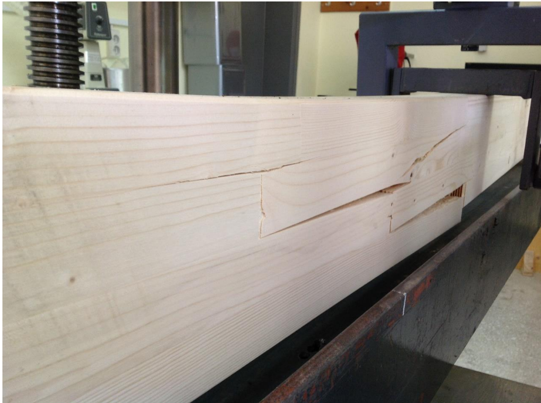
Εικόνα 29.2: Αστοχία επικολλητής δοκού που υπόκειται σε κάμψη
