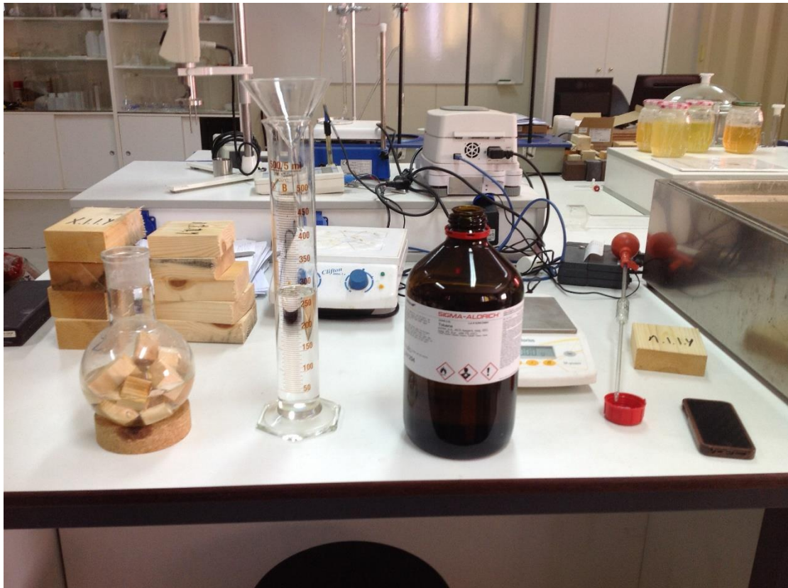
Εικόνα 30.1: Προετοιμασία μείγματος δοκιμίων-τολουολίου
