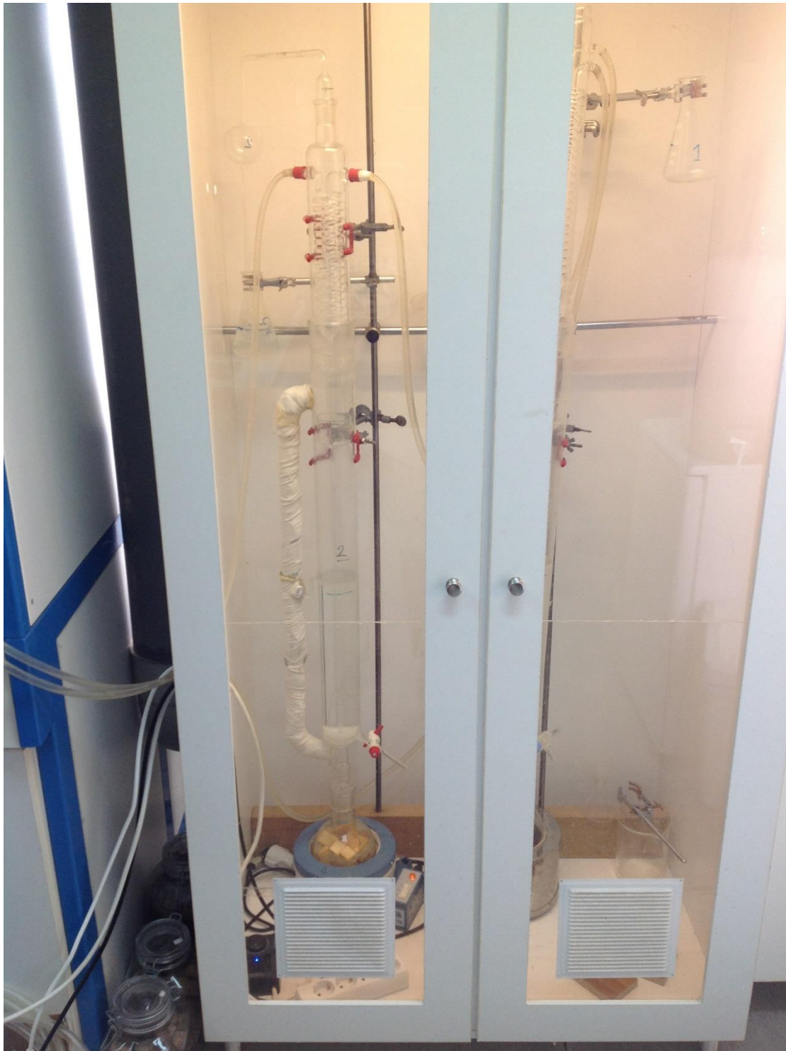
Εικόνα 30.2: Εξοπλισμός μεθόδου εκχύλισης (perforator method)
