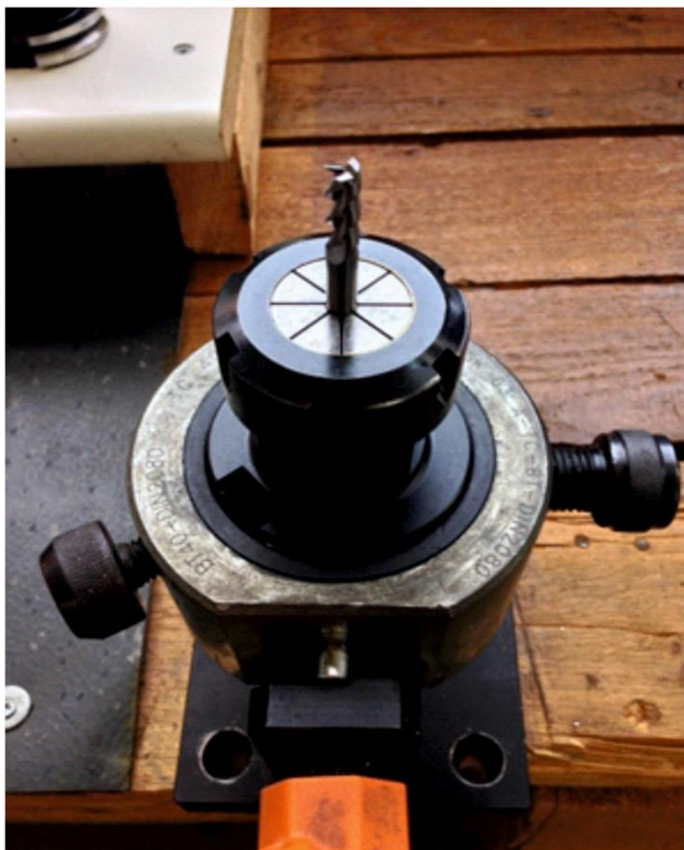
Σχήμα 5.5: Τοποθέτηση κοπτικού εργαλείου στον εργαλειοδέτη μέσω collet
