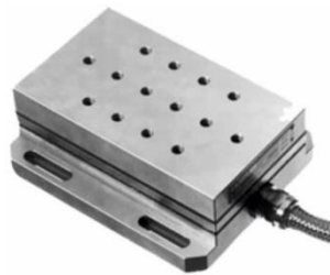
Σχήμα 4.20: Δυναμόμετρο 9257BA και Control Unit 5233A1
