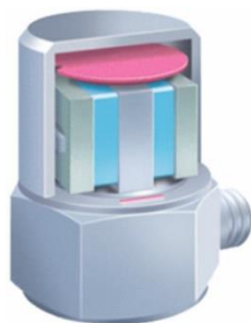
Σχήμα 4.1: Εσωτερική προβολή ενός τυπικού μονού άξονα επιταχυνσιόμετρου
