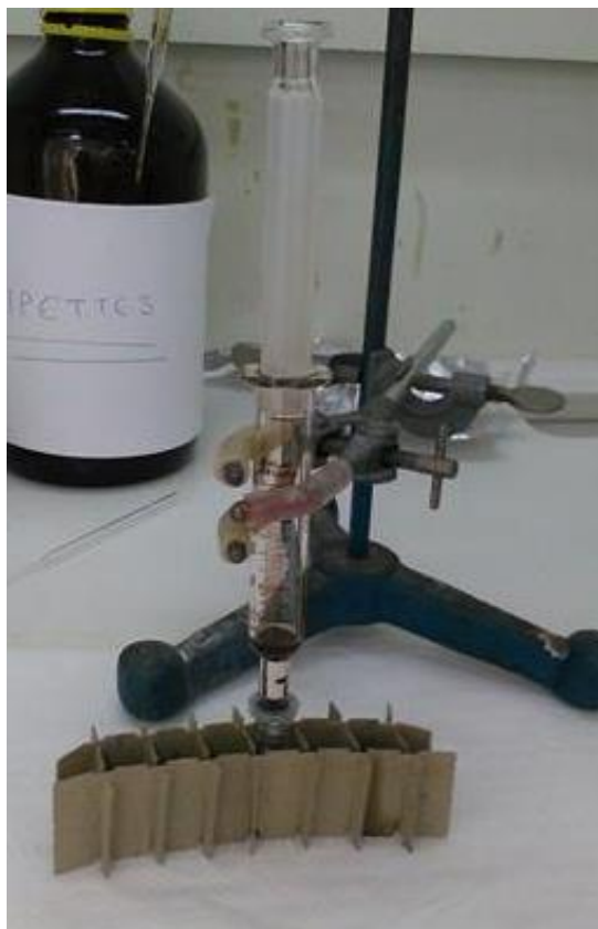
Σχήμα 5.5: Μέθοδος απασφάλτωσης
