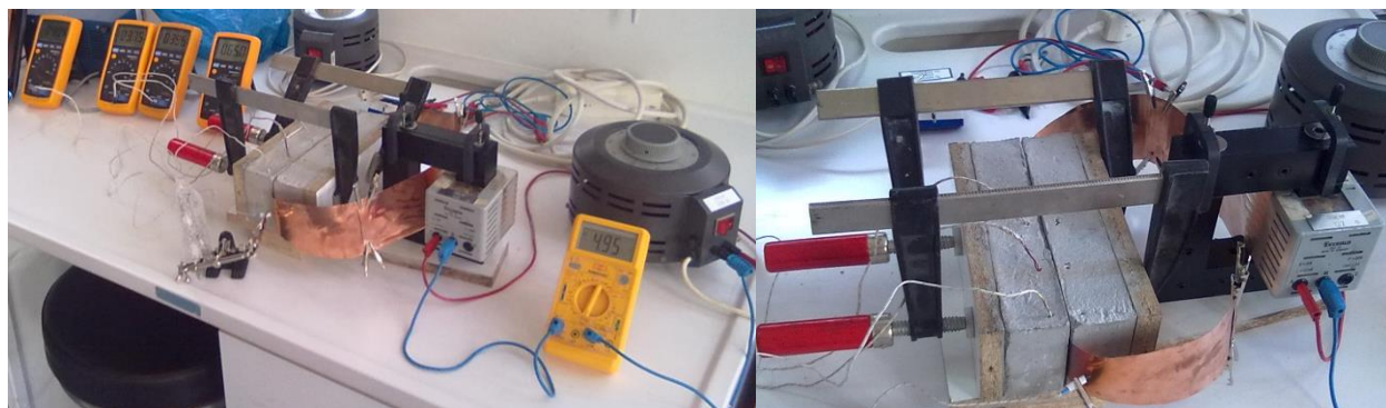
Εικόνα Β.1 Εγκλωβισμός ενός επαγωγικά θερμαινόμενου φύλλου χαλκού ανάμεσα σε δύο δοκίμια σκυροδέματος
