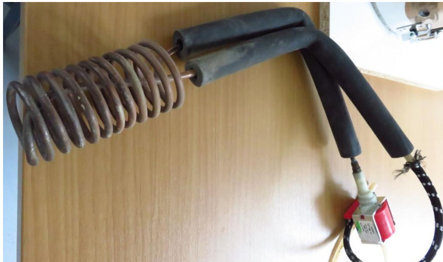
Εικόνα 2.10 Το κύκλωμα του γεωεναλλάκτη θερμότητας μαζί με τον κυκλοφορητή.
