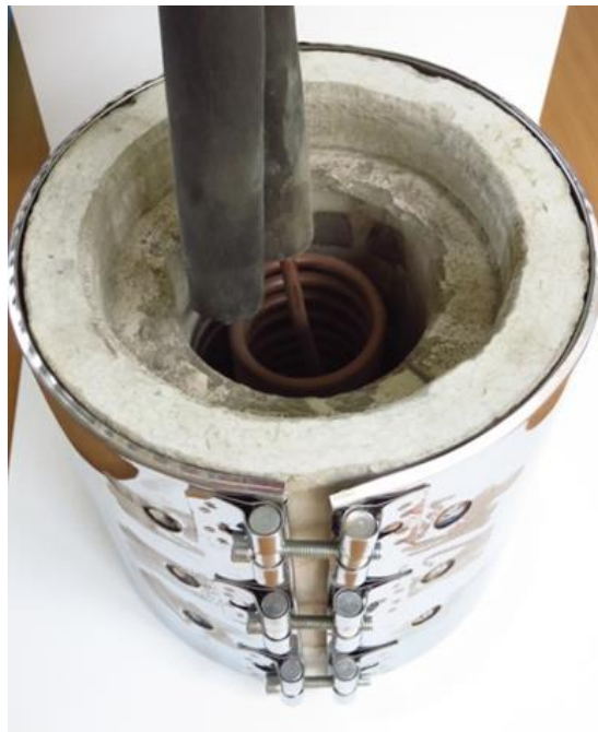
Εικόνα 2.15 Ο γεωεναλλάκτης τοποθετημένος στη μικρογραφία της γεώτρησης. (Δεν έχει γίνει πρόσθεση του υλικού εγκιβωτισμού των αγωγών.)
