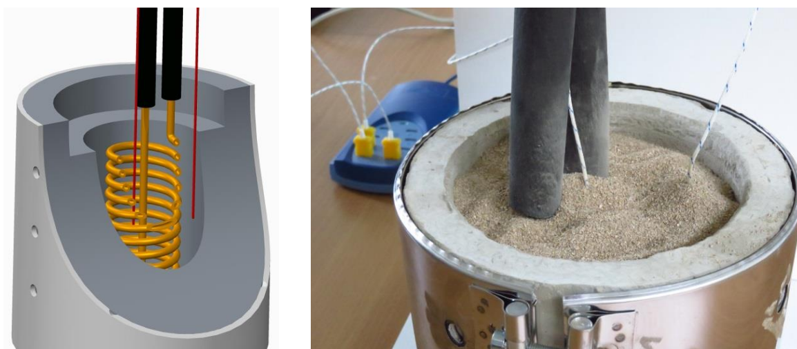
Εικόνα 2.17 Τριδιάστατη απεικόνιση της ακριβούς θέσης τοποθέτησης των θερμοζευγών στο εσωτερικό της γεώτρησης (αριστερά), λεπτομέρεια της διάταξης (δεξιά).
