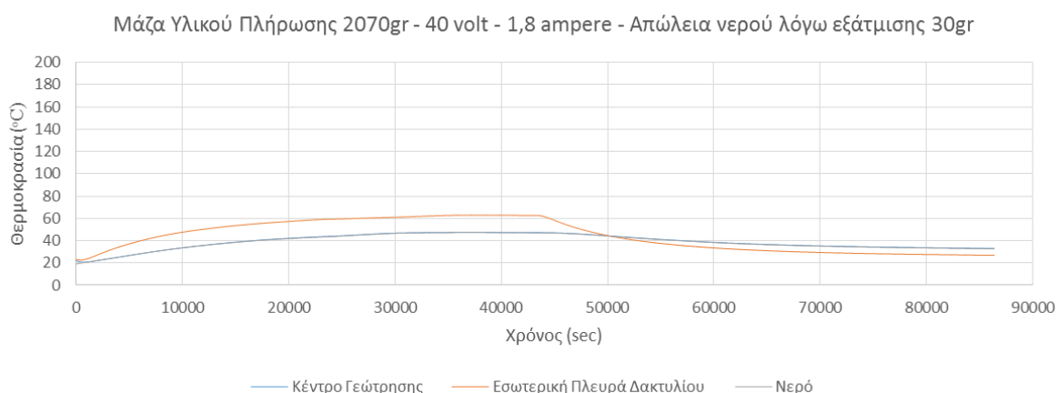
Γραφική Παράσταση 3.1.1α Αποτελέσματα 1 ου πειράματος χρησιμοποιώντας ως υλικό πλήρωσης το κονίαμα κατασκευής των δακτυλίων.
