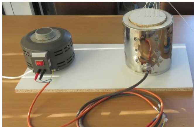
Εικόνα 2.20 Η δεύτερη διάταξη που κατασκευάστηκε στο εργαστήριο μαζί με τη συσκευή ελέγχου της τάσης στα άκρα της αντίστασης.
