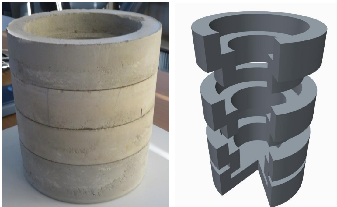
Εικόνα 2.7 Η συναρμολογημένη διάταξη των δακτυλίων (αριστερά η μικρογραφία της γεώτρησης και δεξιά τριδιάστατο σχέδιο της σε τομή).
