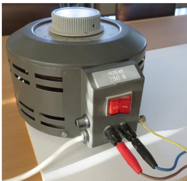
Εικόνα 2.9 Συσκευή διαφοροποίησης της τάσης του εργαστηρίου.
