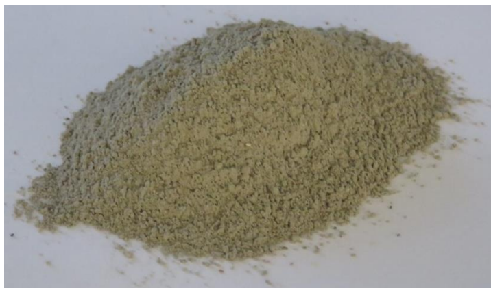
Εικόνα 3.1 Φωτογραφία του κονιάματος που χρησιμοποιήθηκε για την κατασκευή των δακτυλίων της διάταξης, αλλά και ως υλικό πλήρωσης της γεώτρησης.
