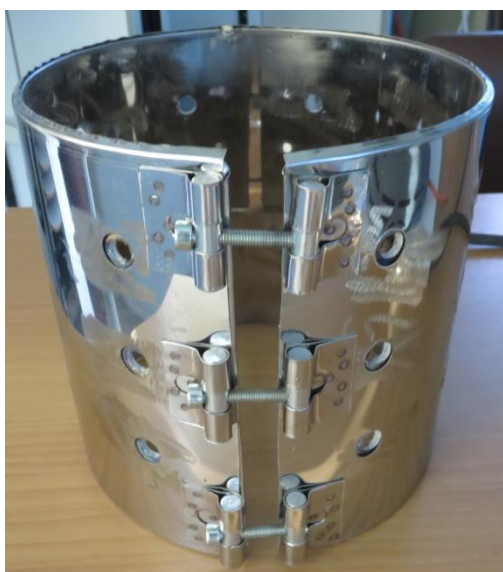
Εικόνα 2.8 Η ηλεκτρική αντίσταση που κατασκευάστηκε στα αριστερά και η συναρμολογημένη διάταξη των δακτυλίων περιβαλλόμενη από την αντίσταση στα δεξιά.
