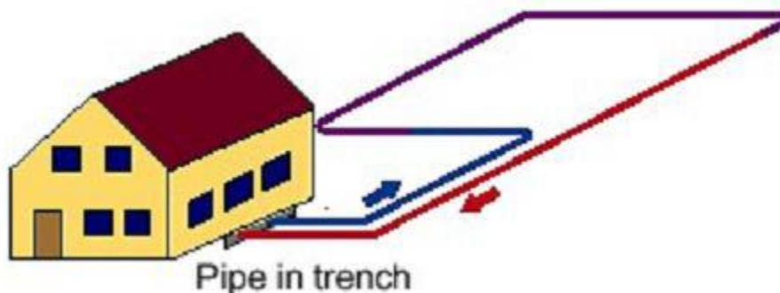
Εικόνα 1.21 Τυπική διάταξη οριζόντιου γεωθερμικού συστήματος κλειστού κυκλώματος. [3]
