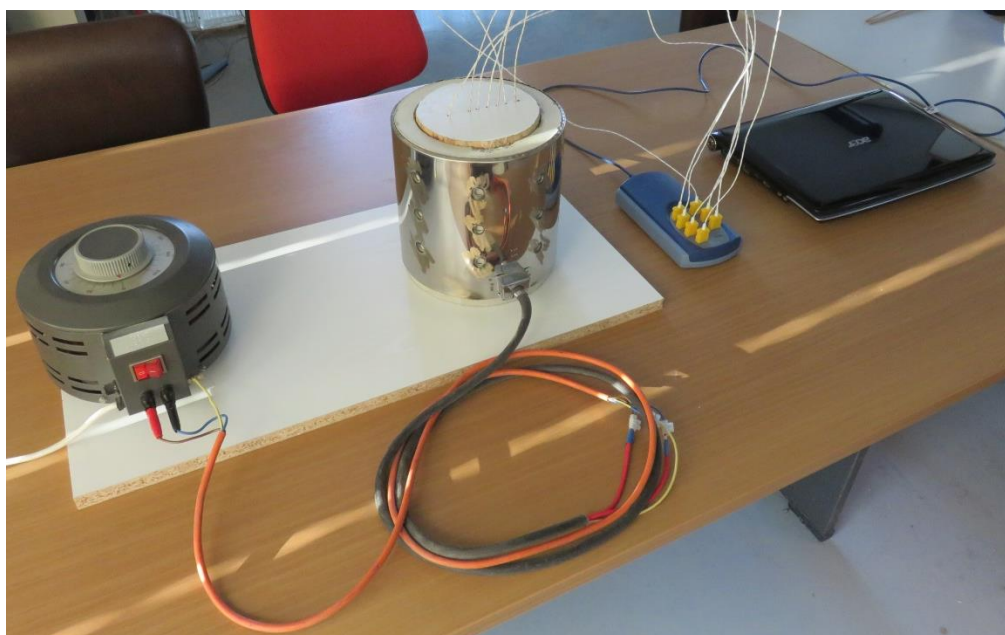
Εικόνα 2.22 Φωτογραφία της δεύτερης διάταξης πειραμάτων όπου διακρίνονται τα μέλη της και ο τρόπος σύνδεσης τους.
