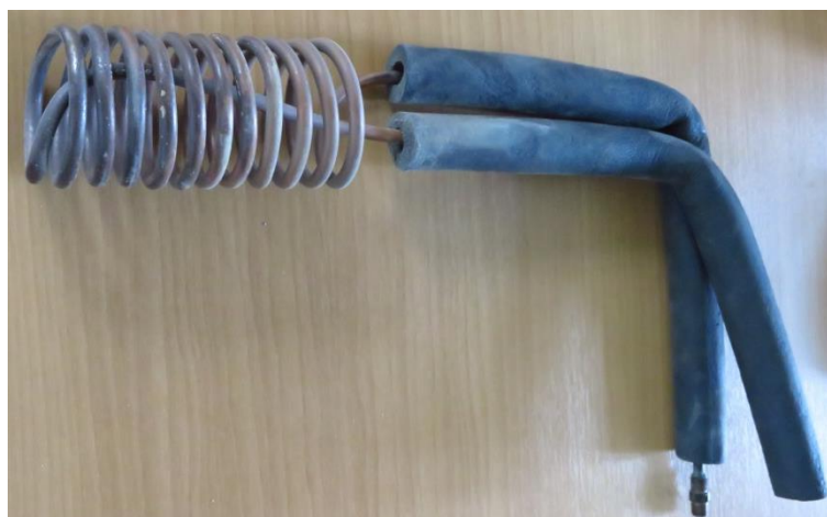
Εικόνα 2.11 Το κύκλωμα του γεωεναλλάκτη θερμότητας με την εξωτερική μόνωση (διακρίνεται το σπείρωμα της σύνδεσης με τον κυκλοφορητή του νερού).
