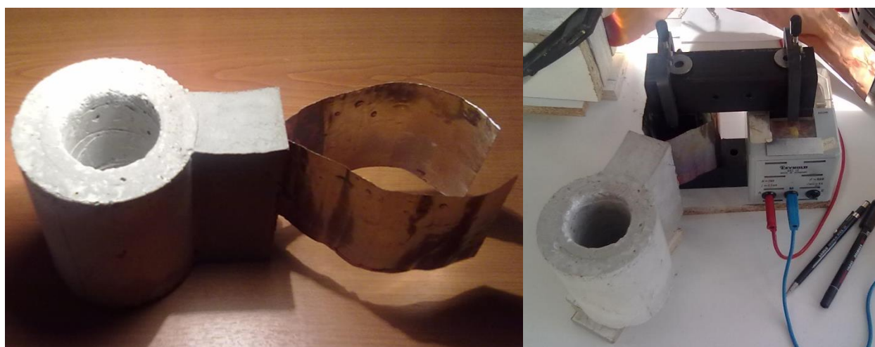
Εικόνα B.3 Θέρμανση δοχείου σκυροδέματος το οποίο ενσωματώνει φύλλο χαλκού.
