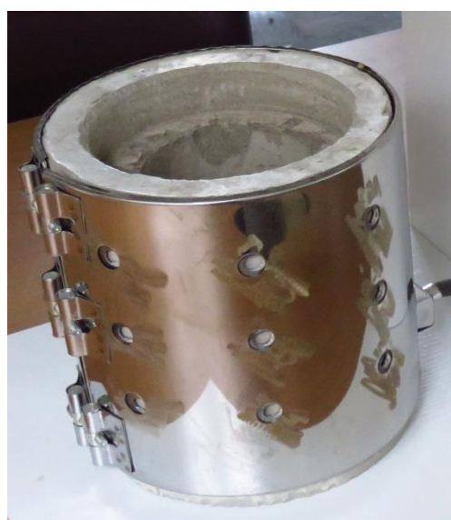
Εικόνα 2.8 Η ηλεκτρική αντίσταση που κατασκευάστηκε στα αριστερά και η συναρμολογημένη διάταξη των δακτυλίων περιβαλλόμενη από την αντίσταση στα δεξιά.
