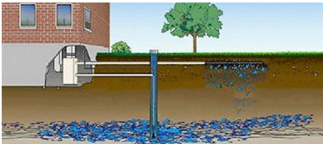
Εικόνα 1.16 Η περίπτωση της υπόγειας διάθεσης των υπό απομάκρυνση υδάτων. [3]
