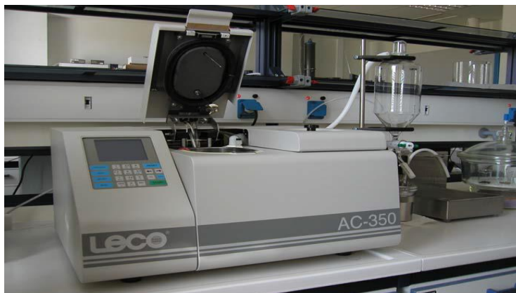
Εικόνα 29. Αυτόματο θερμιδόμετρο (Πηγή: Εργαστηριακές σημειώσεις, 2006)
