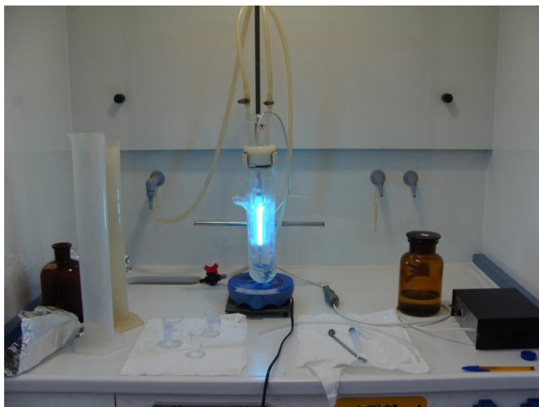
Εικόνα 1. Η πειραματική διάταξη της φωτοκατάλυσης
