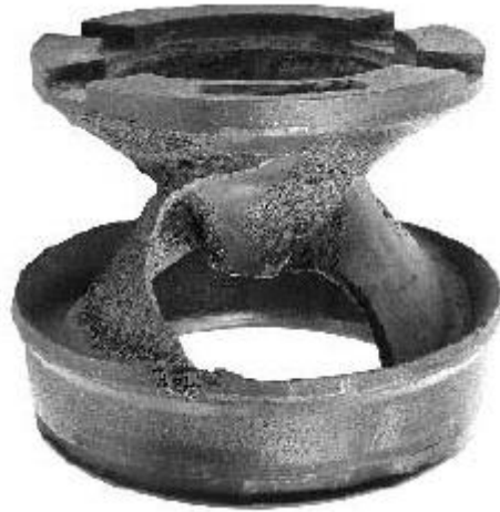
Εικόνα 10 : Μορφή σπηλαιώσης στην πτερωτή αντλίας. [7]
