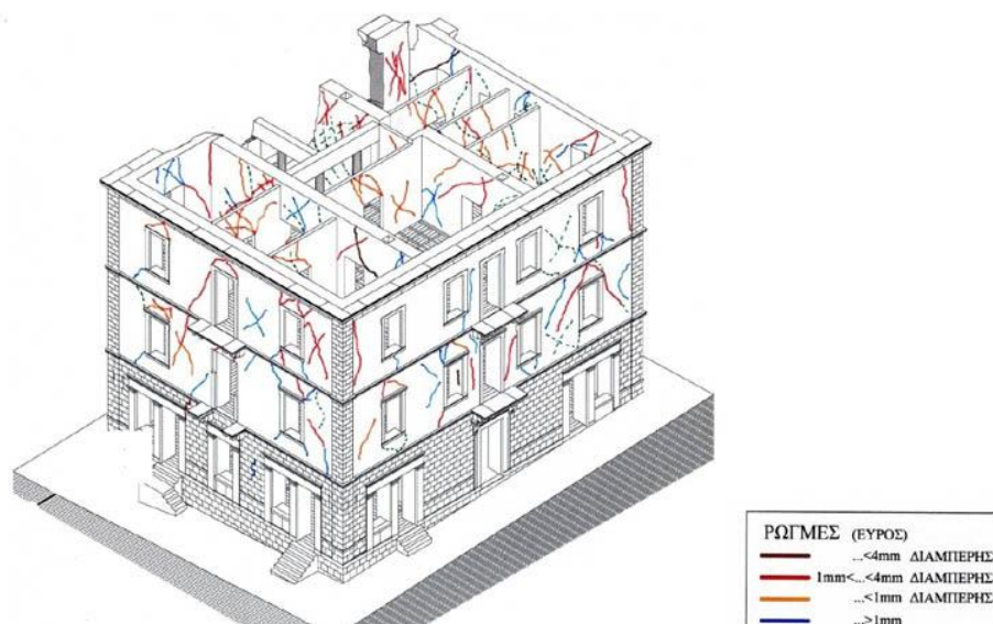
Σχήμα 1. Αποτύπωση των ρωγμών του κτηρίου.
