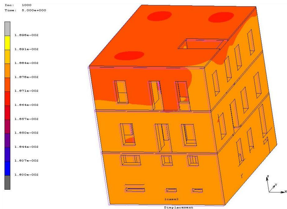
Σχήμα 9.31 Συνολικές μετακινήσεις της κατασκευής στο τελευταίο βήμα της ανάλυσης.
