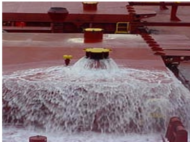
Εικόνα 9: Flow-through Ballast Water Exchange Method (Πηγή: www.csamarenosturm.hr )
