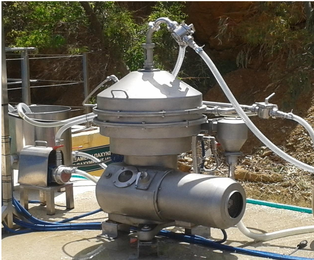
Εικόνα 1.4.2 : Φυγοκεντρικό φίλτρο
