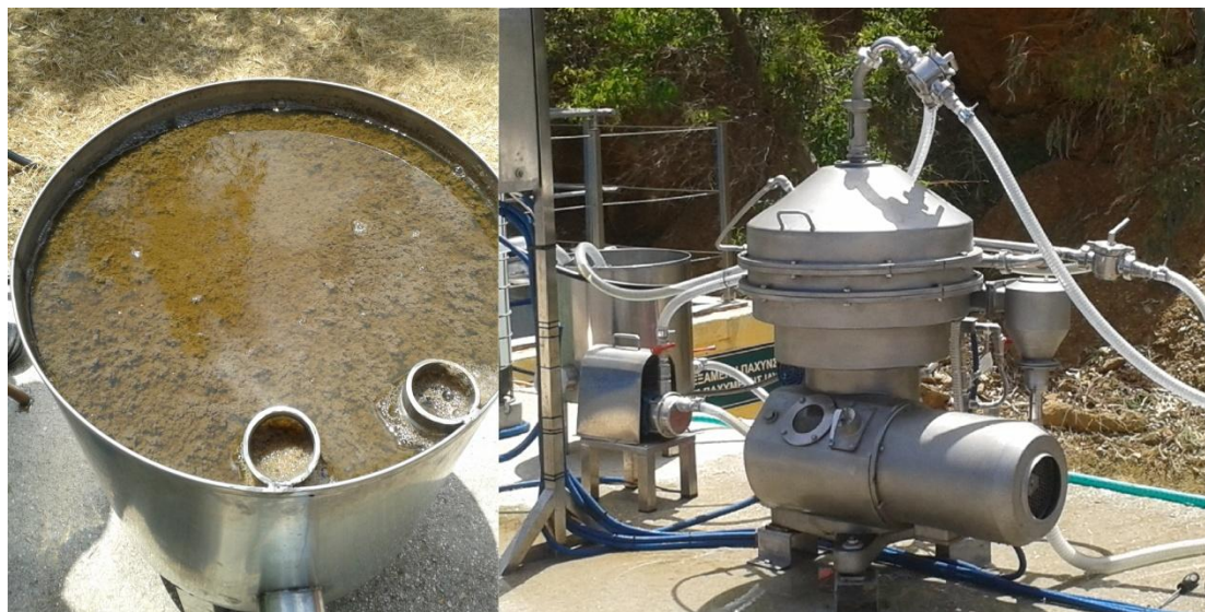
Εικόνα 3.2.2 : αριστερά είναι η δεξαμενή κροκίδωσης και δεξιά είναι η διάταξη της .
