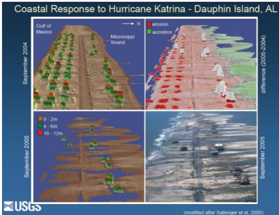
Εικόνα 46: Αεροφωτογραφίες Lidar πριν και μετά του χτυπήματος του τυφώνα Κατρίνα στο νησί Dauphin
