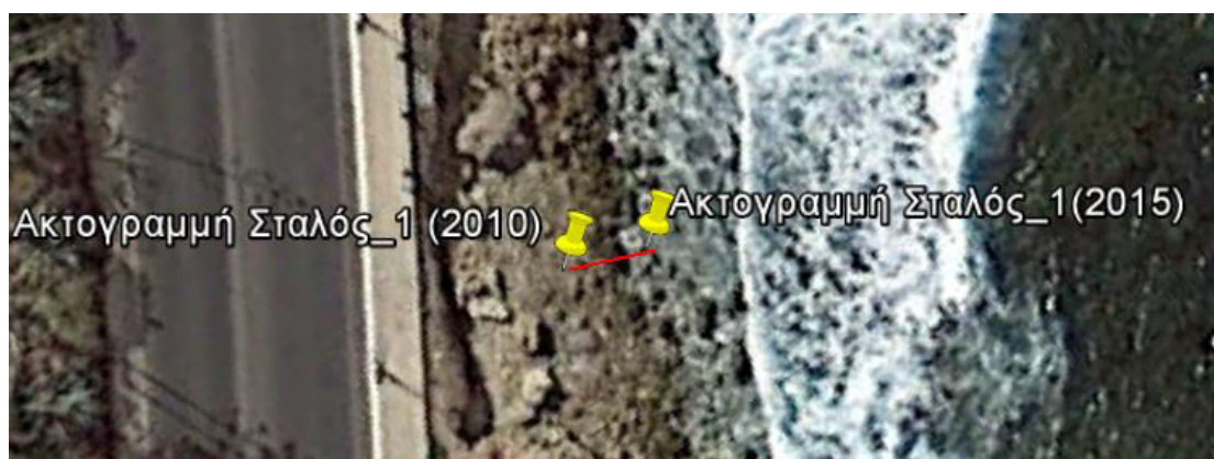
Εικόνα 12: Μεταβολή της ακτογραμμής σε διάρκεια πέντε ετών (2010-2015) στο πρώτο τμήμα του Κάτω Σταλού (Πηγή: Google earth)
