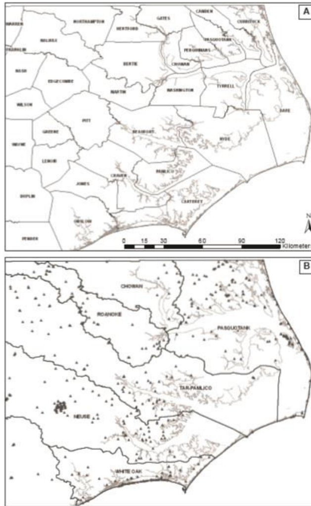
Εικόνα 47: Α) Πολιτείες της Βορειοανατολικής Καρολίνας Β) Η ταυτοποίηση των λεκανών απορροής Τα τρίγωνα στην εικόνα 1B υποδηλώνουν τις θέσεις των γεωδαιτικών σημείων αναφοράς για την αξιολόγηση της ακρίβειας του συνόλου των δεδομένων ανύψωσης
