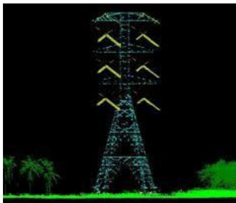
Εικόνα 41: Εφαρμογές της τεχνολογίας Lidar στις 3D μοντελοποιήσεις των γραμμών μεταφοράς ενέργειας (πηγή: www.geomatics.gr )
