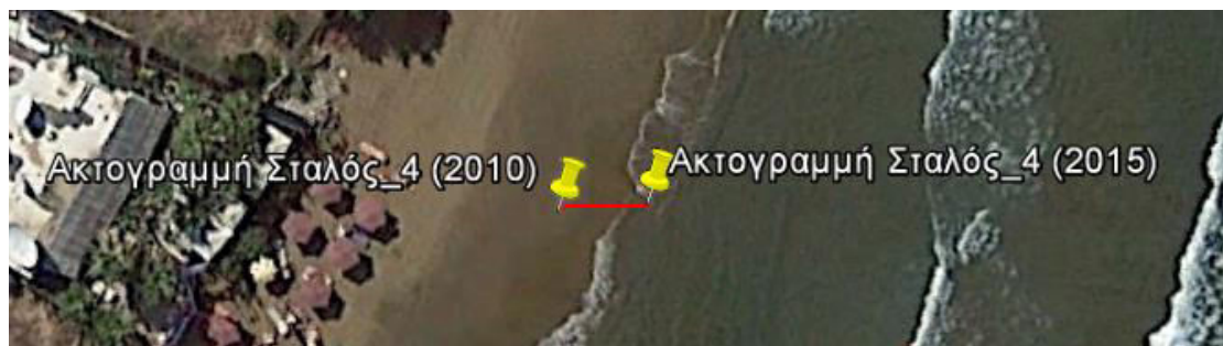
Εικόνα 15: Μεταβολή της ακτογραμμής σε διάρκεια πέντε ετών (2010-2015) στο τέταρτο τμήμα του Κάτω Σταλού (Πηγή: Google Earth)
