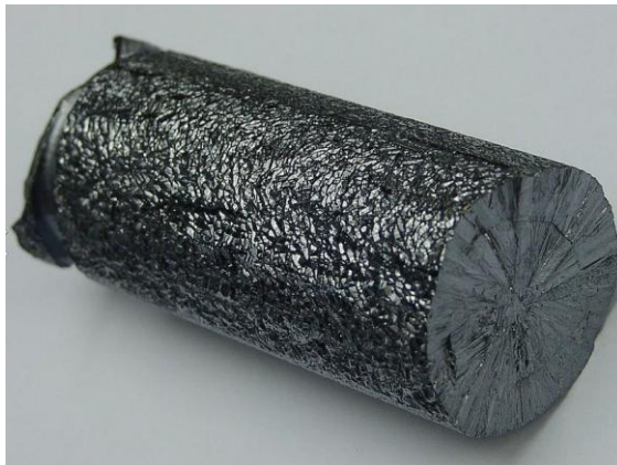
Εικόνα 3.9 : Ράβδος πολυκρυσταλλικού πυριτίου [10]
