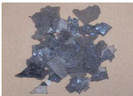
Εικόνα 4.21 : Άλλα συστατικά ενός ΦΒ πλαισίου CIS, μετά από άλεσμα και σύνθλιψη [13]
