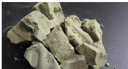
Εικόνα 4.19 : Λάσπη ημιαγωγικού υλικού κατά την διεργασία ανακύκλωσης της First Solar [13]
