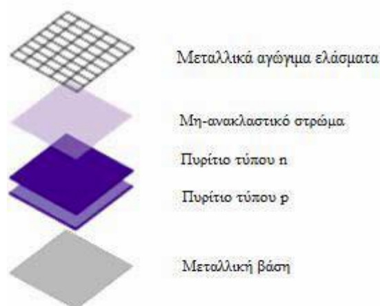
Εικόνα 3.2 : Δομή ΦΒ στοιχείου [7]
