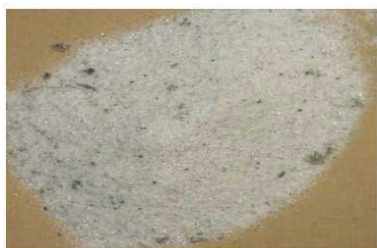
Εικόνα 4.20 : Κλάσμα γυαλιού από ΦΒ πλαίσιο CIS, μετά από άλεσμα και σύνθλιψη [13]
