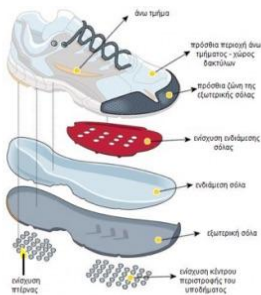
Εικόνα 2.1 Τα μέρη του υποδήματος
