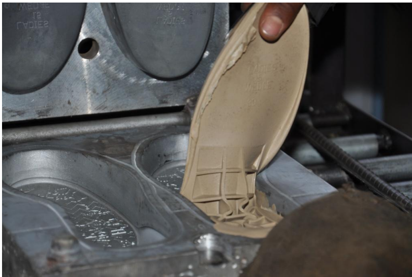
Εικόνα 4.3 Η σόλα όταν αφαιρείται από τη μήτρα
