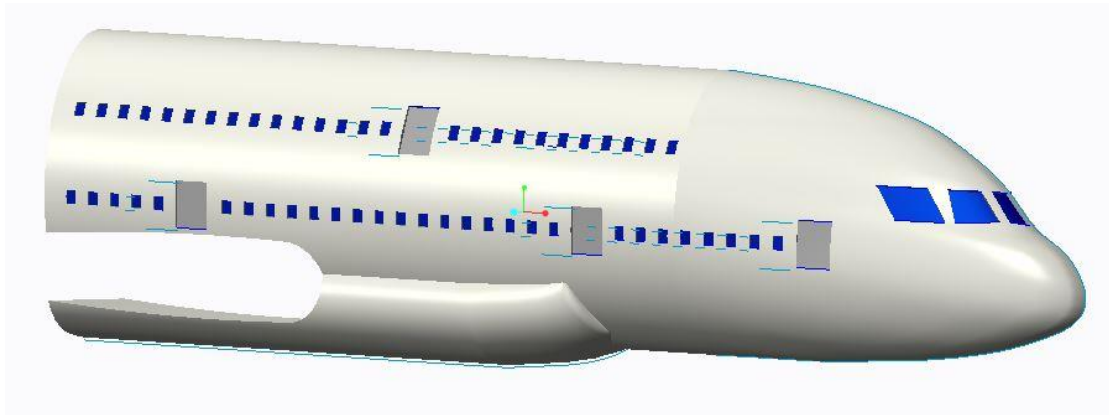
Εικόνα 33: Εμπρός τμήμα του κορμού του αεροπλάνου σχεδιασμένο στο Creo.
