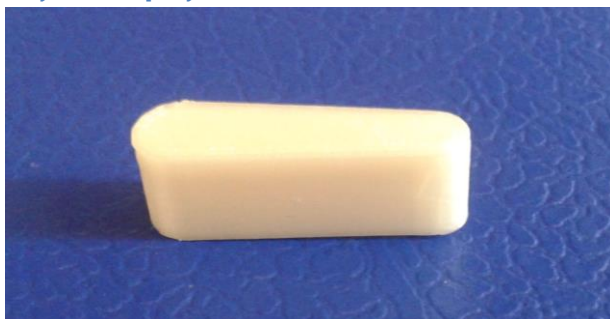
Εικόνα 69: Δοκιμαστικό τεμάχιο για τον έλεγχο της συναρμολόγησης.
