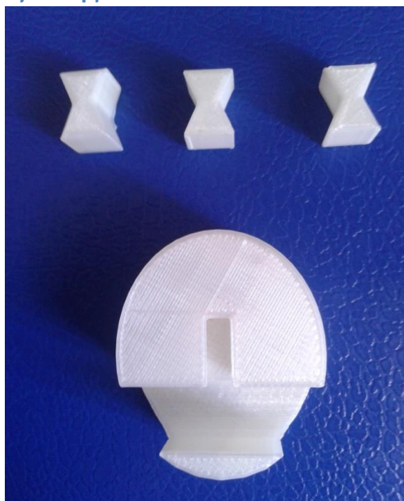
Εικόνα 68: Δοκιμαστικά τεμάχια για τον έλεγχο της συναρμολόγησης.
