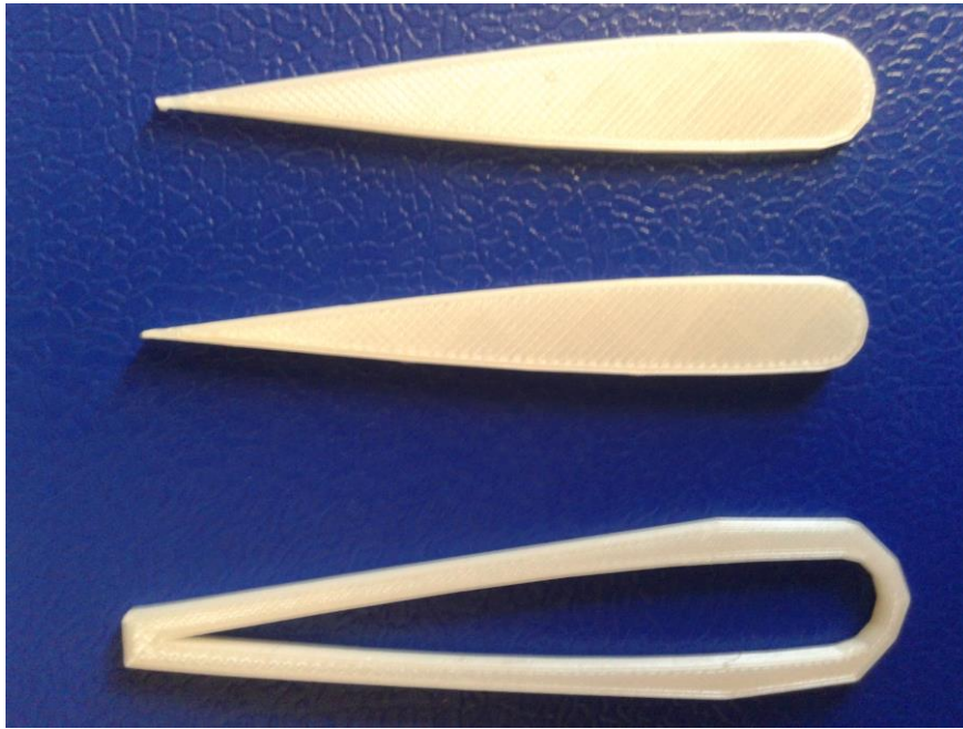
Εικόνα 71: Δοκιμαστικά τεμάχια για τον έλεγχο της συναρμολόγησης.
