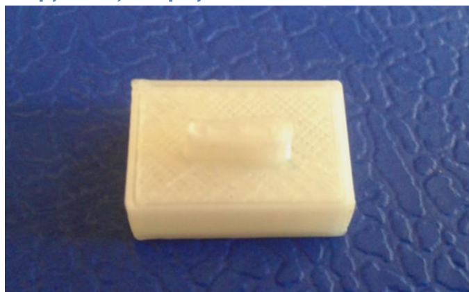
Εικόνα 70: Δοκιμαστικό τεμάχιο για τον έλεγχο της συναρμολόγησης.
