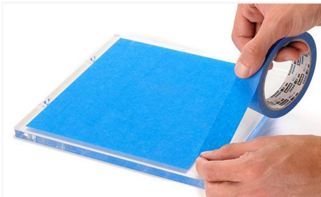
Εικόνα 10: Τοποθέτηση μπλε ταινίας στην πλατφόρμα εκτύπωσης.
