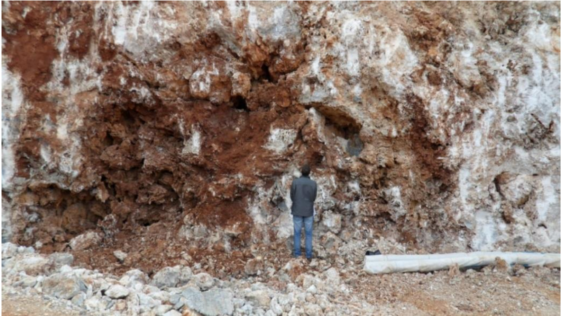
Εικόνα 2: Πληρωμένες σπηλαιώσεις (Τεχνική έκθεση γεωλογικής επισκόπησης, Εμμ. Μανούτσογλου 2014)
