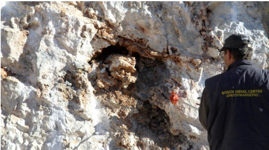
Εικόνα 3: Κενές σπηλαιώσεις (Τεχνική έκθεση γεωλογικής επισκόπησης, Εμμ. Μανούτσογλου 2014)
