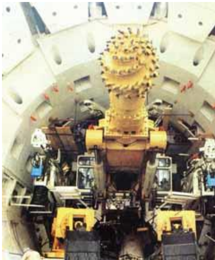
Σχήμα 2-2: Η ασπίδα ανοιχτού μετώπου OFS που διακρίνεται η κεφαλή σημειακής κοπής ( www.herrenknecht.com )
