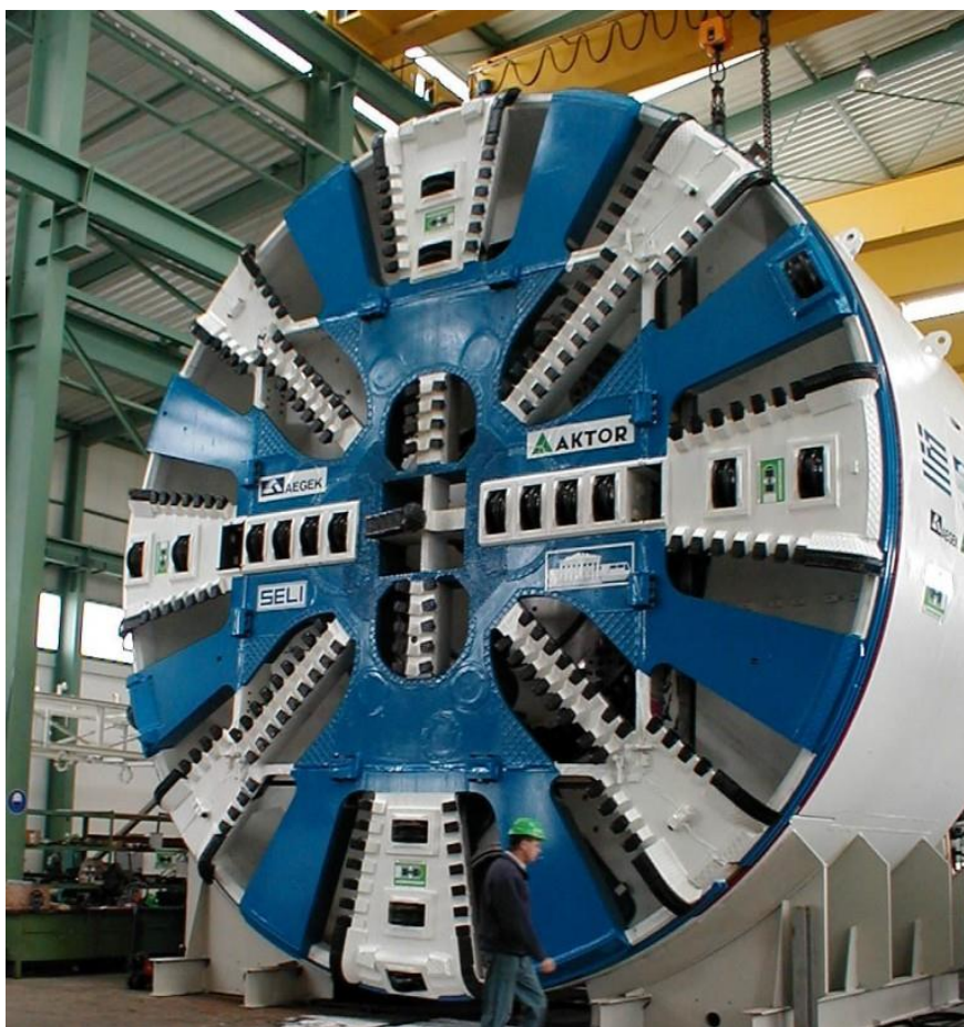
Σχήμα 2-3: Ασπίδα εξισορρόπησης πίεσης εδάφους (EPB) - εργοστάσιο κατασκευής Herrenknecht (Αττικό Μετρό, 2009)
