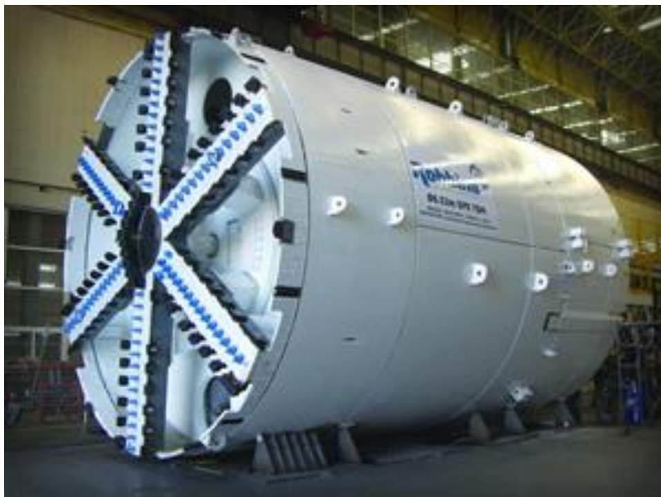
Σχήμα 3-7: Κοπτική κεφαλή EPB-TBM (Robbins Company: www.therobbinscompany.com )
