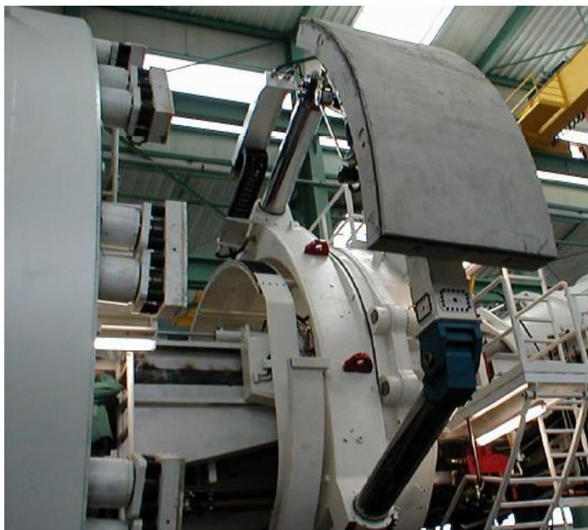
Σχήμα 3-10: Σύστημα ανύψωσης και τοποθέτησης προκατασκευασμένων στοιχείων (Αττικό Μετρό, 2011)
