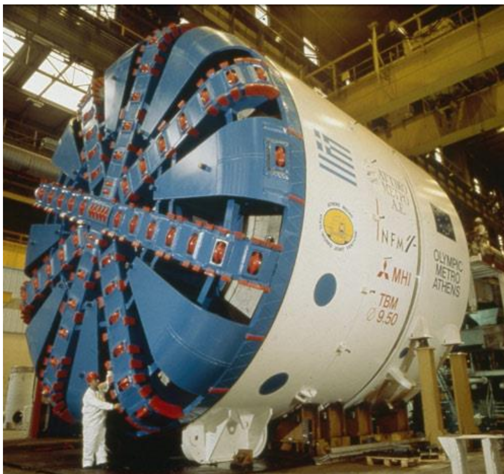
Σχήμα 2-1: Κεφαλή κοπής του «ΙΑΣΟΝΑ» (εργοστάσιο κατασκευής NFM Γαλλία - Αττικό Μετρό ΑΕ: www.ametro.gr )
