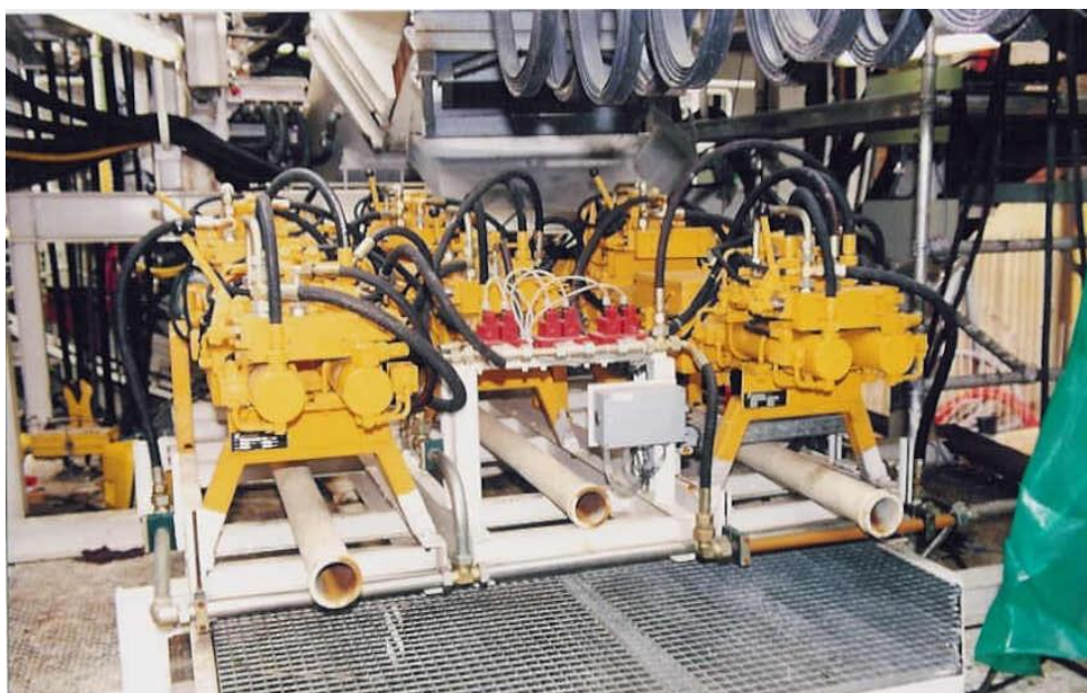
Σχήμα 3-8: Εμβολοφόρες αντλίες τσιμεντοκονιάματος (Αττικό Μετρό, 2009)
