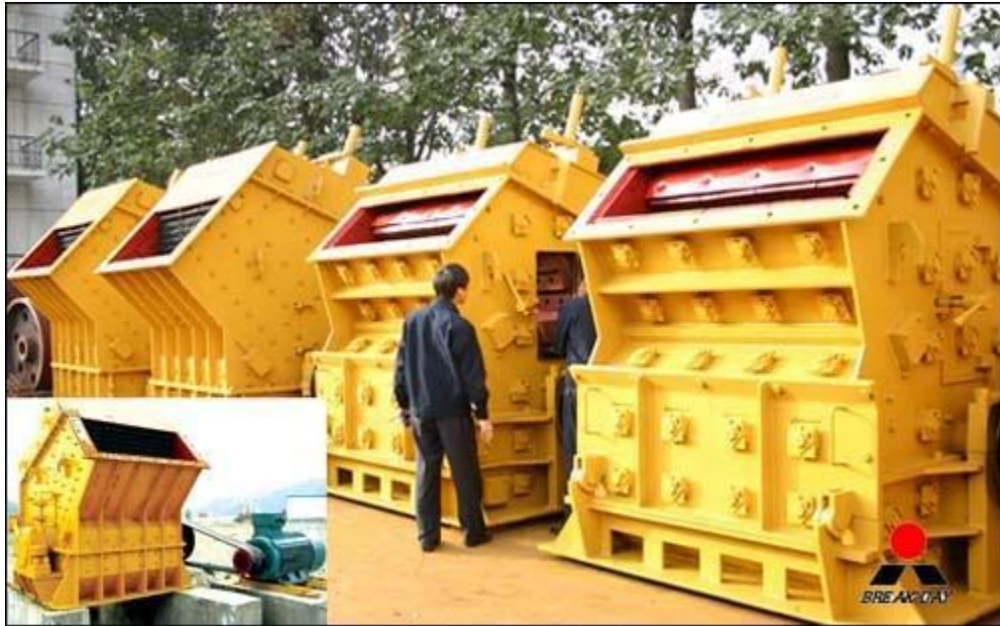
Σχήμα 4.8: Περιστροφικός θραυστήρας με σφυριά
