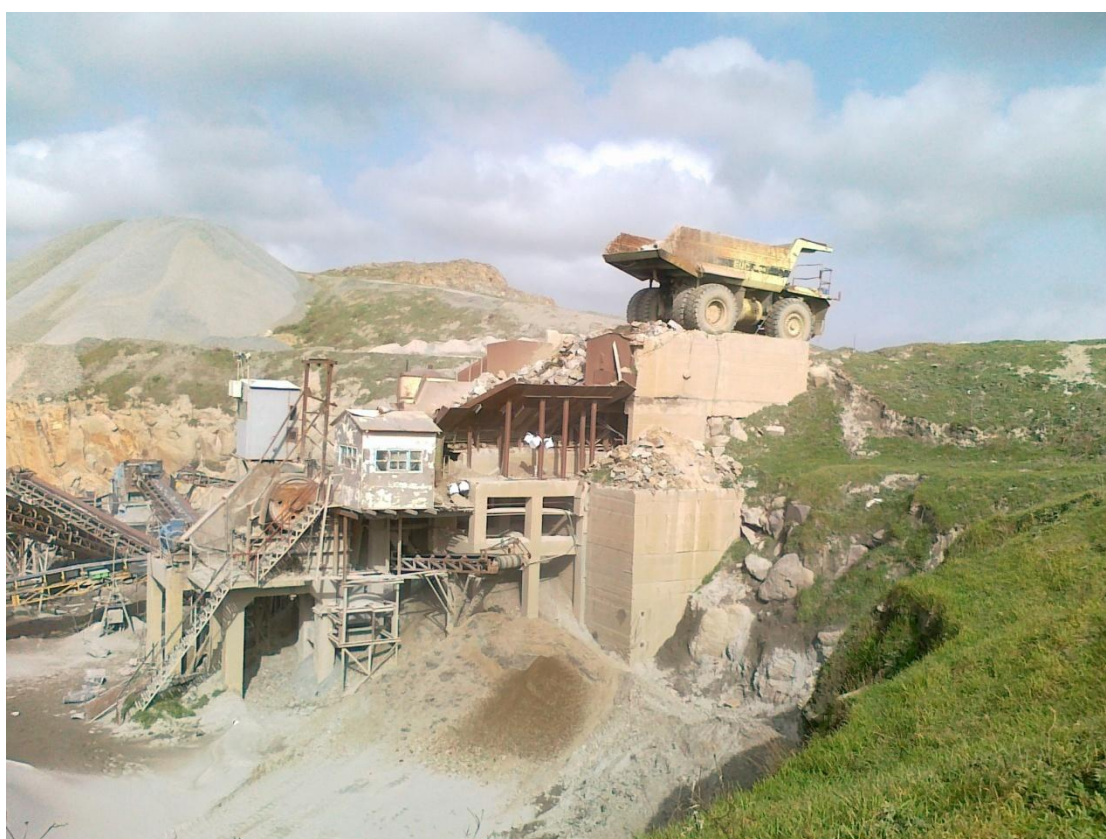
Σχήμα 5.9: Οριζόντια διάταξη Συγκροτήματος Θραύσης
