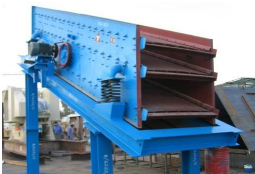
Σχήμα 4.9: Δονούμενο κόσκινο με τρία παράλληλα πλέγματα
