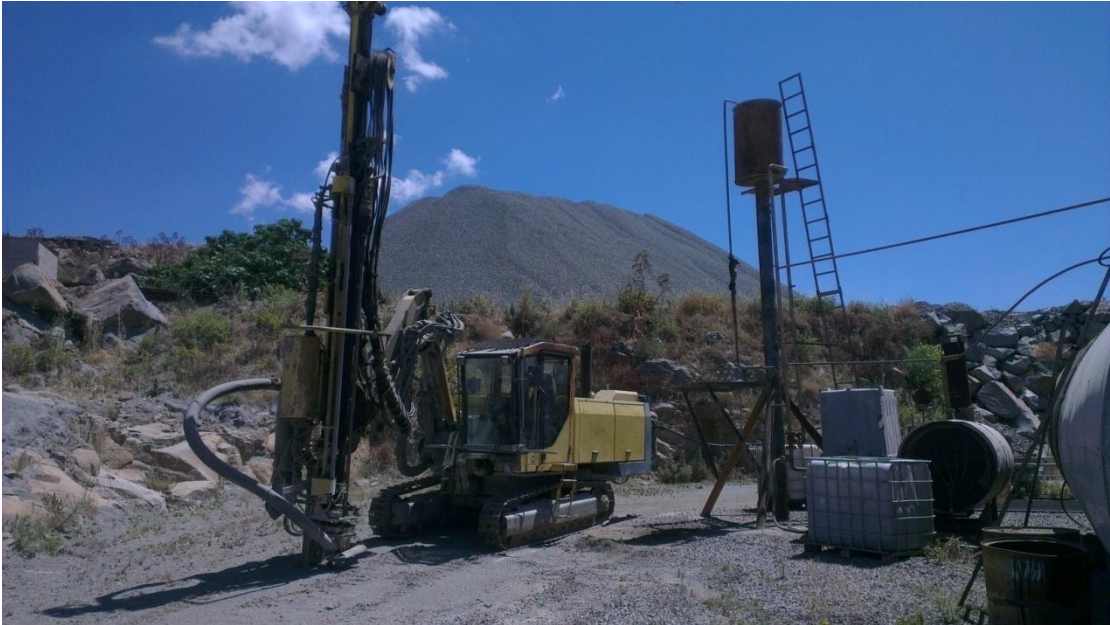
Εικόνα 4.2: Διατρητικό φορείο με καμπίνα χειριστού Atlas-Corpo
