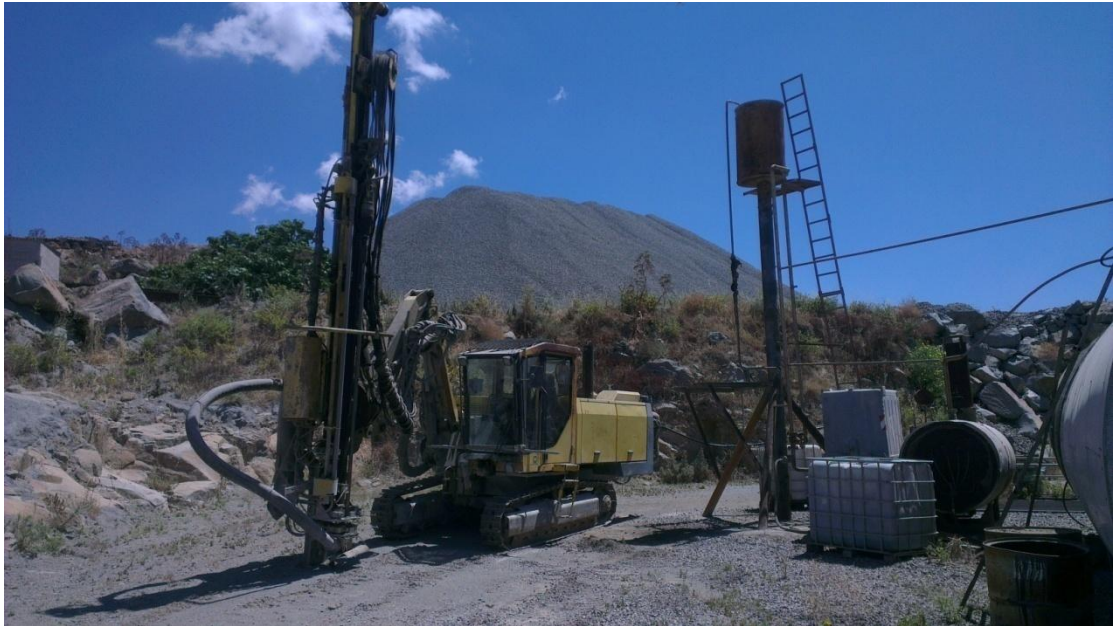
Σχήμα 5.5: Διατρητικό φορείο με αερόσφυρα και καμπίνα χειριστού
