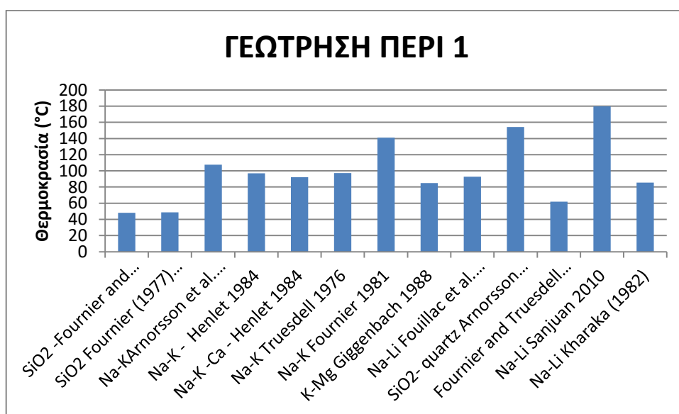
Σχήμα 6.7 Αποτελέσματα γεωθερμομέτρων γεώτρησης Περί1.
