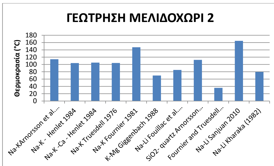
Σχήμα 6.13 Αποτελέσματα γεωθερμομέτρων γεώτρησης Μελιδοχώρι2.
