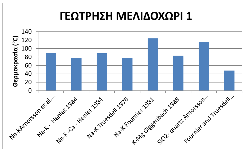
Σχήμα 6.12 Αποτελέσματα γεωθερμομέτρων γεώτρησης Μελιδοχώρι1.
