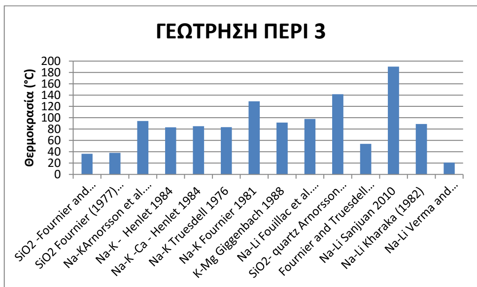
Σχήμα 6.9 Αποτελέσματα γεωθερμομέτρων γεώτρησης Περί3.
