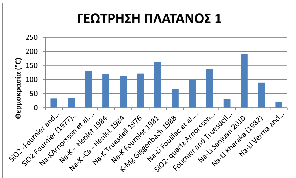
Σχήμα 6.10 Αποτελέσματα γεωθερμομέτρων γεώτρησης Πλάτανος1.
