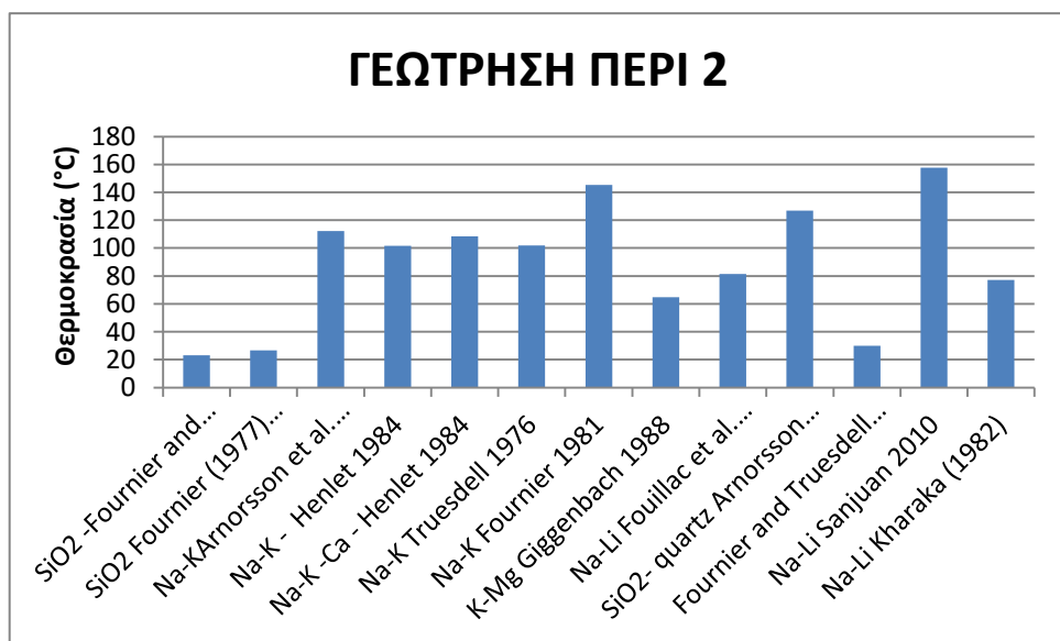
Σχήμα 6.8 Αποτελέσματα γεωθερμομέτρων γεώτρησης Περί2.
