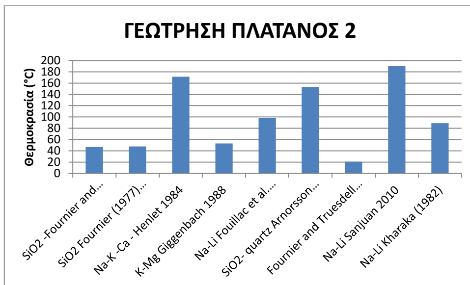
Σχήμα 6.11 Αποτελέσματα γεωθερμομέτρων γεώτρησης Πλάτανος2.
