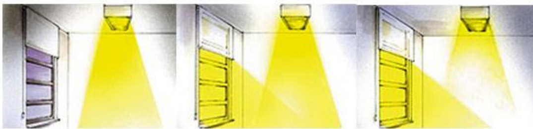
Εικ. 4.1 : Σύστημα ρύθμισης φωτεινής ροής
