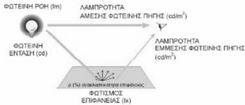
Σχήμα. 1.2 : Τρόπος μετάδοσης φωτεινής ροής
