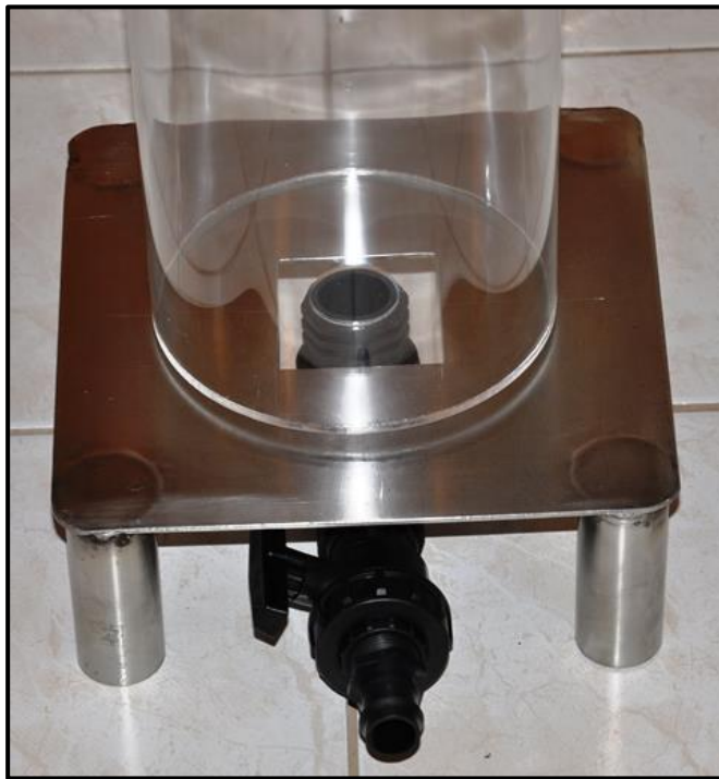
Εικόνα 29, Ανοξείδωτη βάση σταλακτικού φίλτρου και βάνα εκροής επεξεργασμένων υγρών αποβλήτων.
