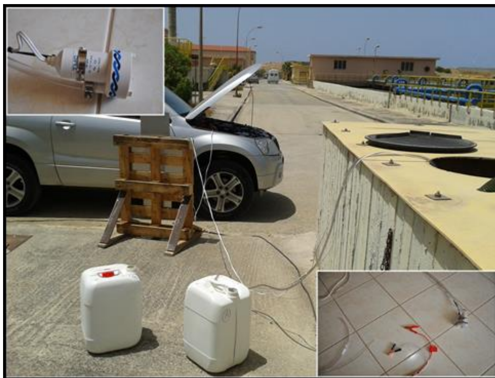
Εικόνα 36, Άντληση αποβλήτων από την εγκατάσταση του βιολογικού καθαρισμού του Δήμου Χανίων, με τη βοήθεια βυθιζόμενης αντλίας 12volts.
