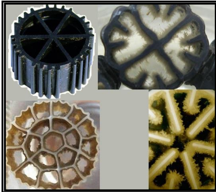
Εικόνα 34, Ενεργοποιημένη βιομάζα (activated sludge) που αναπτύχθηκε στο πληρωτικό υλικό που χρησιμοποιήθηκε στα σταλακτικά φίλτρα της παρούσας εργασία (φωτογραφία πάνω αριστερά). [ World Water Works, 2014], [YULONG, 2016]
