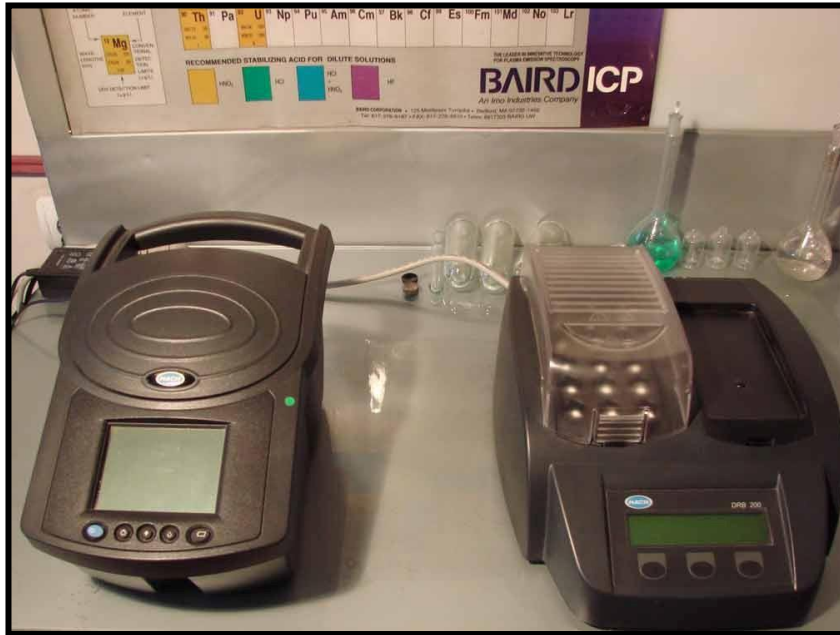
Εικόνα 26, Συσκευή πέψης (δεξιά) και φορητό φασματοφωτόμετρο (αριστερά) που χρησιμοποιούνται για τον προσδιορισμό του COD και του TOC.
