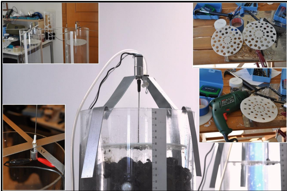
Εικόνα 33, Στάδια κατασκευής συστήματος διαβροχής
