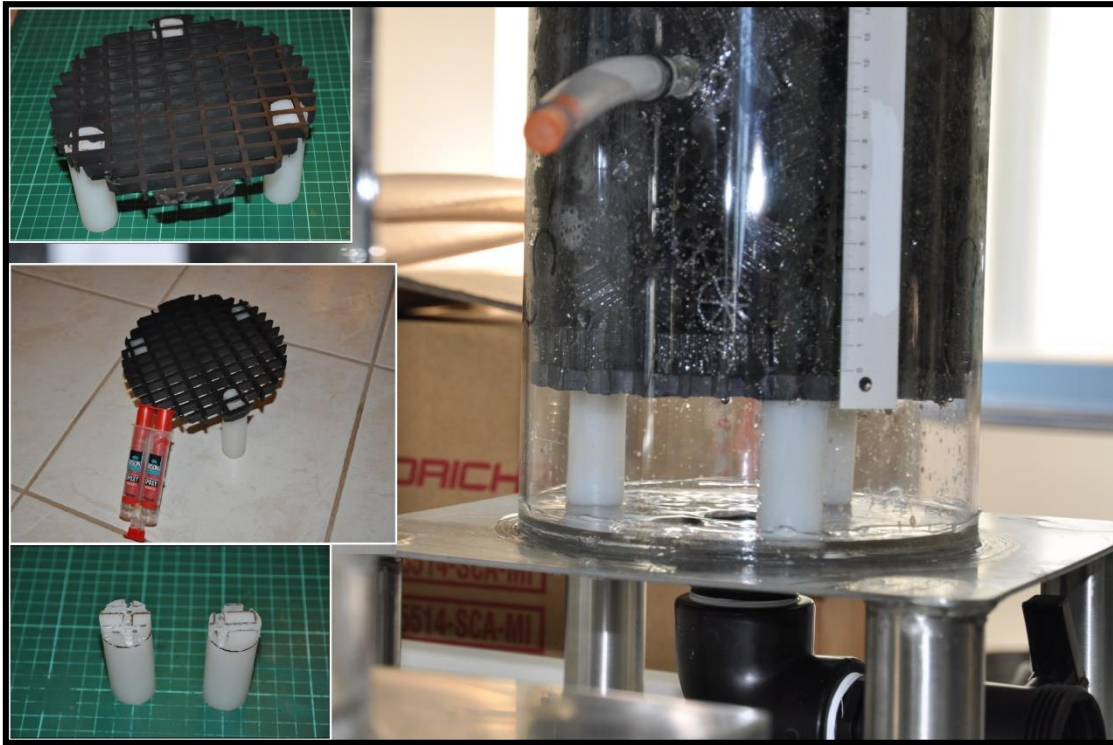
Εικόνα 31, Στάδια κατασκευής συστήματος αποστράγγισης
