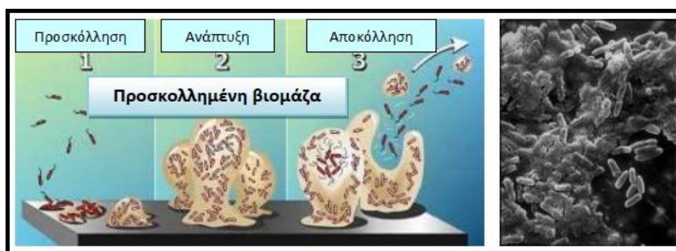
Εικόνα 6, Σχηματική απεικόνιση των διεργασιών στην επιφάνεια των βιοφορέων των σταλακτικών φίλτρων. [Σωτηρίου, 2012]
