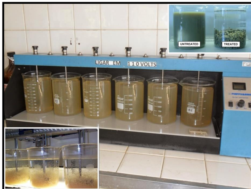
Εικόνα 3, Εργαστηριακή δοκιμή κροκίδωσης (Jar test)
