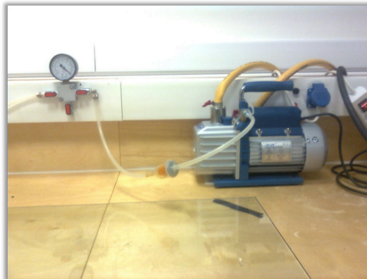
Σχήμα 4.5: Διάταξη αντλίας κενού - μανόμετρου. Φαίνεται και ο υαλοπίνακας που χρησιμοποιήθηκε ως καλούπι για τα σύνθετα υλικά.
