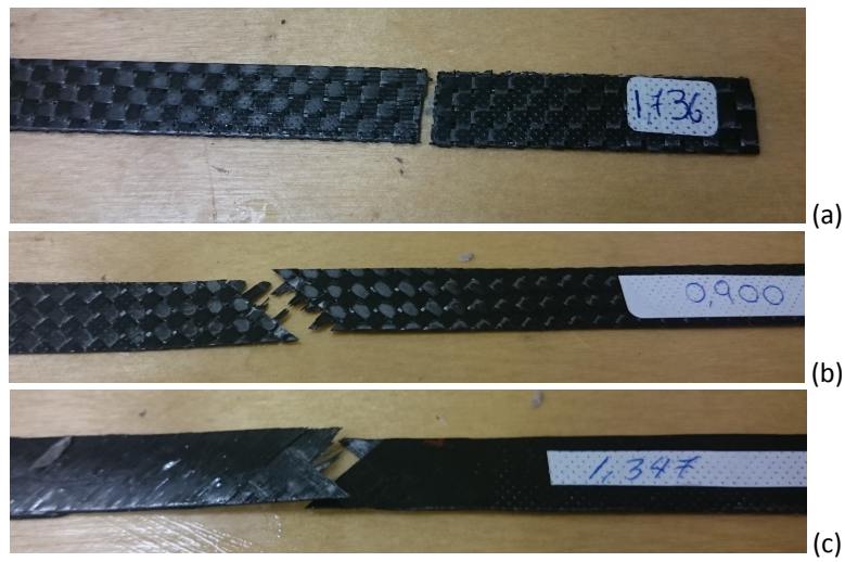
Σχήμα 6.1: Σύγκριση του τρόπου θραύσης δοκιμίων τα οποία φορτίστηκαν εφελκυστικά σε γωνία 0^\circ (a) ή 45^\circ (b: υφασμένο, c: μονοαξονικό) ως προς τον άξονα των ινών τους.
