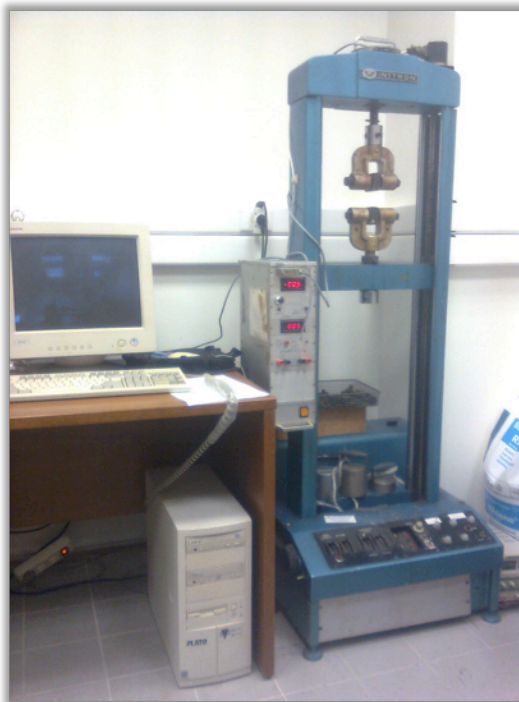
Σχήμα 4.6: Διάταξη μηχανής εφελκυσμού - ηλεκτρονικού υπολογιστή
