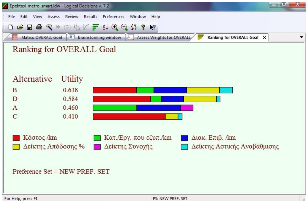
Εικόνα 4.12. Τελική κατάταξη εναλλακτικών όπως προκύπτει από την επίλυση με τη μέθοδο SMART, μέσω του λογισμικού Logical Decisions για το πρόβλημα επέκταση μετρό.
