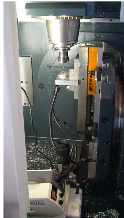
Σχήμα 3.23: Εξοπλισμός των πειραμάτων στο κέντρο κατεργασίας DMG DMU 50 ecoline
