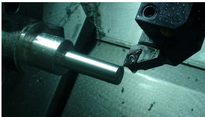
Σχήμα 3.11: Τοποθέτηση και αρχική διαμόρφωση του υλικού στο κέντρο τόννευσης DMG CTX 30 ecoline
