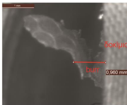
Μέτρηση ύψους του burr
