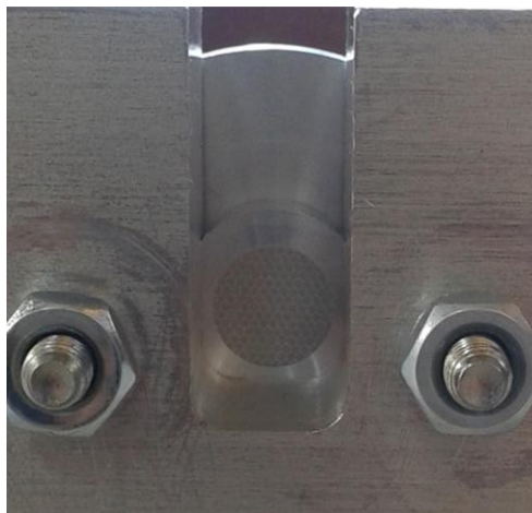
Σχήμα 3.20: Εφαρμογή δοκιμίου στην ιδιοκατασκευή
