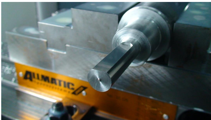
Σχήμα 3.13: Δημιουργία εγκοπής στα 6.5mm πάνω από το κέντρο του κυλίνδρου διαμέτρου 12mm
