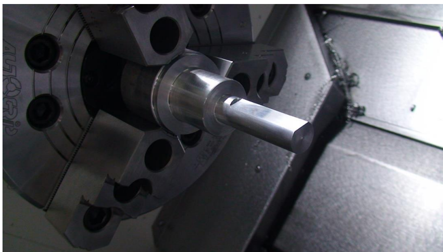
Σχήμα 3.14: Στάδιο κοπής των εννέα, ίδιων διαστάσεων, δοκιμίων
