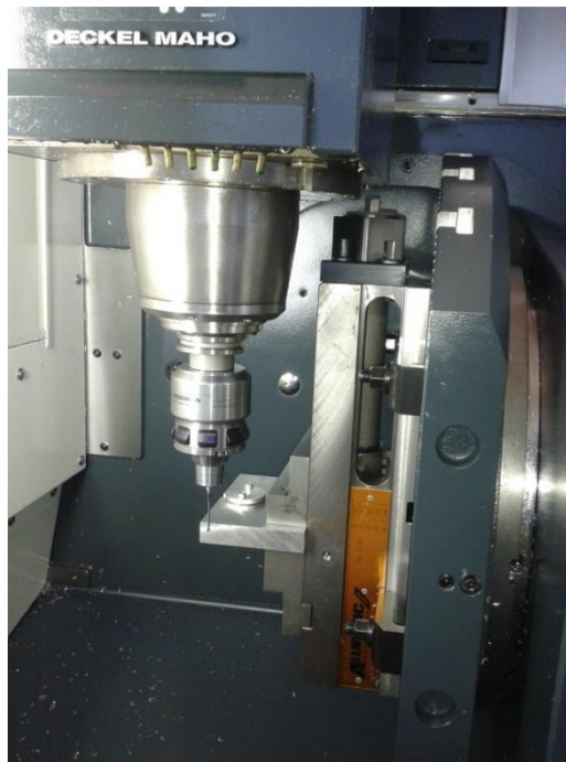
Σχήμα 3.22: Εντοπισμός συντεταγμένων ιδιοκατασκευής με χρήση ανιχνευτή ακμών Heidenhain TS 642
