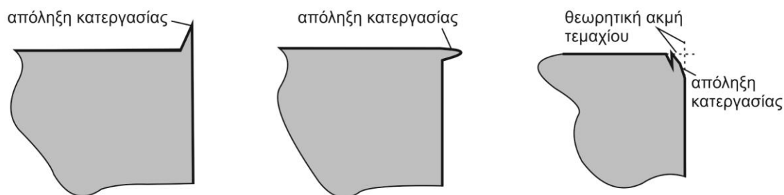
Σχήμα 2.3 : Παραδείγματα χαρακτηριστικών απολήξεων σύμφωνα με τον Gillespie
