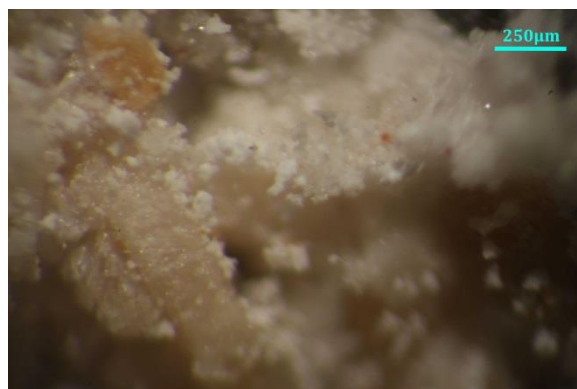
Σχήμα 85: Φωτογραφίες του κονιάματος ΦΡ3Κ από οπτικό μικροσκόπιο. Το κονίαμα είναι συμπαγές με καλή επαφή και συγκόλληση αδρανών-κονίας. Εμφανίζει επιφανειακά εξανθήσεις αλάτων.
