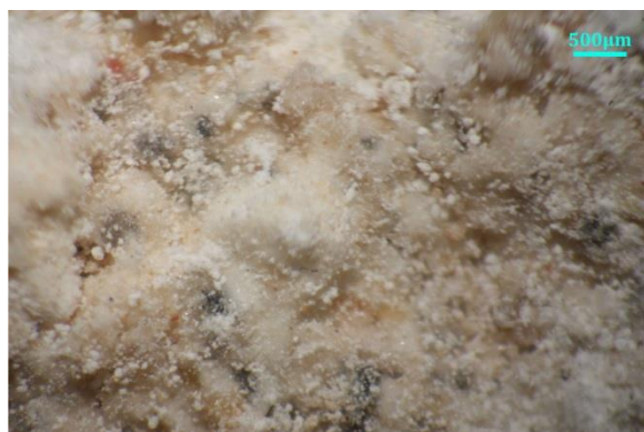
Σχήμα 85: Φωτογραφίες του κονιάματος ΦΡ3Κ από οπτικό μικροσκόπιο. Το κονίαμα είναι συμπαγές με καλή επαφή και συγκόλληση αδρανών-κονίας. Εμφανίζει επιφανειακά εξανθήσεις αλάτων.
