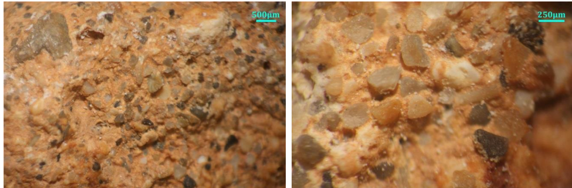
Σχήμα 93: Φωτογραφίες του επιχρίσματος ΦΡ9Ε από οπτικό μικροσκόπιο. Περιέχει ανάλογη δομή με τα περισσότερα επιχρίσματα, όμως έχει εντονότερο χρωματισμό ώχρας, που παραπέμπει ίσως σε χρήση κεραμάλευρο ή αργλικών συστατικών, όπως σε οθωμανικά κονιάματα.
