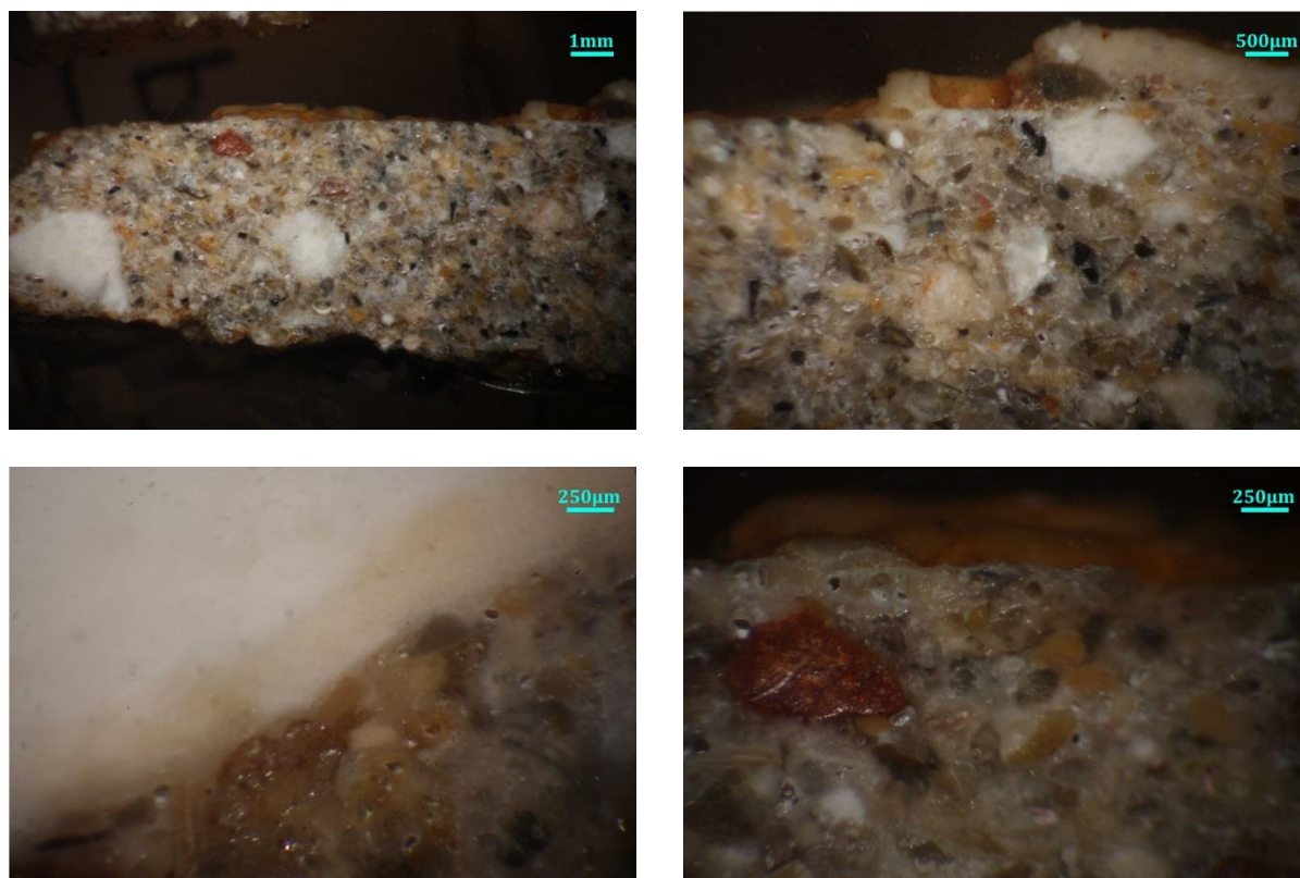
Σχήμα 104: Φωτογραφίες στιλπνών τομών του επιχρίσματος ΦΡ17Ε από οπτικό μικροσκόπιο. Η δομή του μοιάζει πολύ με αρκετών επιχρισμάτων, με τα οποία μπορεί να ομαδοποιηθεί ως προς τη χρονολόγησή του.
