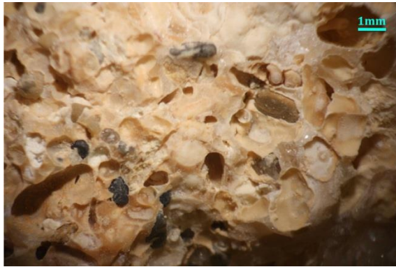
Σχήμα 107: Φωτογραφίες του λίθου ΦΡ18Λ από οπτικό μικροσκόπιο. Παρατηρούνται ποικίλοι σχηματισμοί και διαφορετικά υλικά που συνθέτουν τον βιοκλαστικό ασβεστόλιθο, καθώς και αρκετοί μεγάλοι πόροι.
