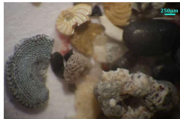
Σχήμα 109: Φωτογραφίες της θαλάσσιας άμμου ΦΡΑΜΜ από το οπτικό μικροσκόπιο. Στην άμμο περιέχονται αρκετά ανοιχτόχρωμα αδρανή που δε φαίνονται μακροσκοπικά, καθώς και πληθώρα θαλάσσιων κελυφών. Η μορφή πολλών από τα κελύφη παραπέμπει άμεσα σε όσα παρατηρήθηκαν στην επιφάνεια των δειγμάτων.
