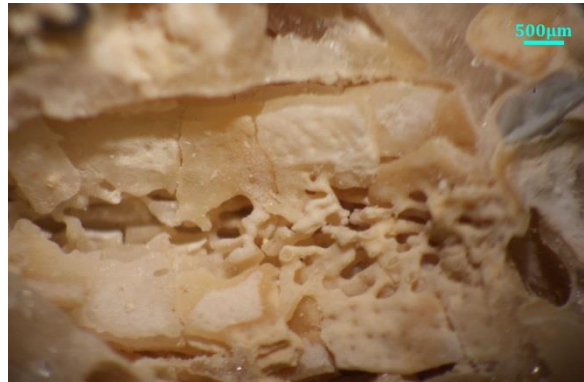
Σχήμα 107: Φωτογραφίες του λίθου ΦΡ18Λ από οπτικό μικροσκόπιο. Παρατηρούνται ποικίλοι σχηματισμοί και διαφορετικά υλικά που συνθέτουν τον βιοκλαστικό ασβεστόλιθο, καθώς και αρκετοί μεγάλοι πόροι.
