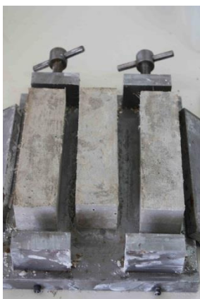
Σχήμα 145: Δοκίμια ΦΡ-ΚΟΝ ελέγχου μηχανικών αντοχών.
