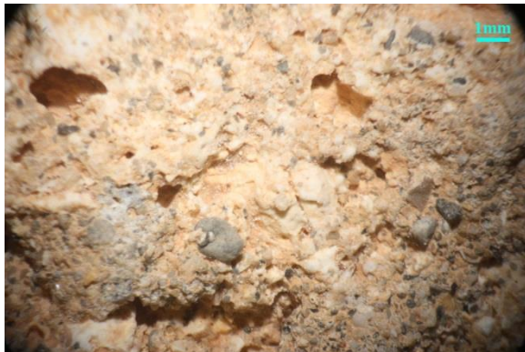
Σχήμα 81: Φωτογραφίες του επιχρίσματος ΦΡ1Ε από οπτικό μικροσκόπιο. Είναι εμφανής η καλή επαφή μεταξύ κονίας και λίθου, όπως και η συμπαγής δομή της κονίας, η οποία έχει χρωματισμό ώχρας.
