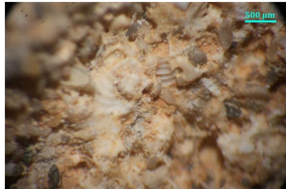
Σχήμα 81: Φωτογραφίες του επιχρίσματος ΦΡ1Ε από οπτικό μικροσκόπιο. Είναι εμφανής η καλή επαφή μεταξύ κονίας και λίθου, όπως και η συμπαγής δομή της κονίας, η οποία έχει χρωματισμό ώχρας.
