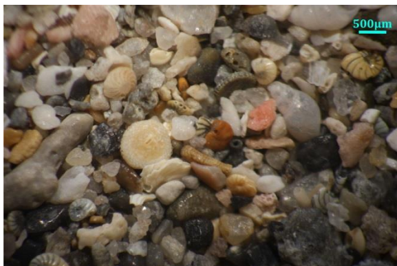
Σχήμα 109: Φωτογραφίες της θαλάσσιας άμμου ΦΡΑΜΜ από το οπτικό μικροσκόπιο. Στην άμμο περιέχονται αρκετά ανοιχτόχρωμα αδρανή που δε φαίνονται μακροσκοπικά, καθώς και πληθώρα θαλάσσιων κελυφών. Η μορφή πολλών από τα κελύφη παραπέμπει άμεσα σε όσα παρατηρήθηκαν στην επιφάνεια των δειγμάτων.
