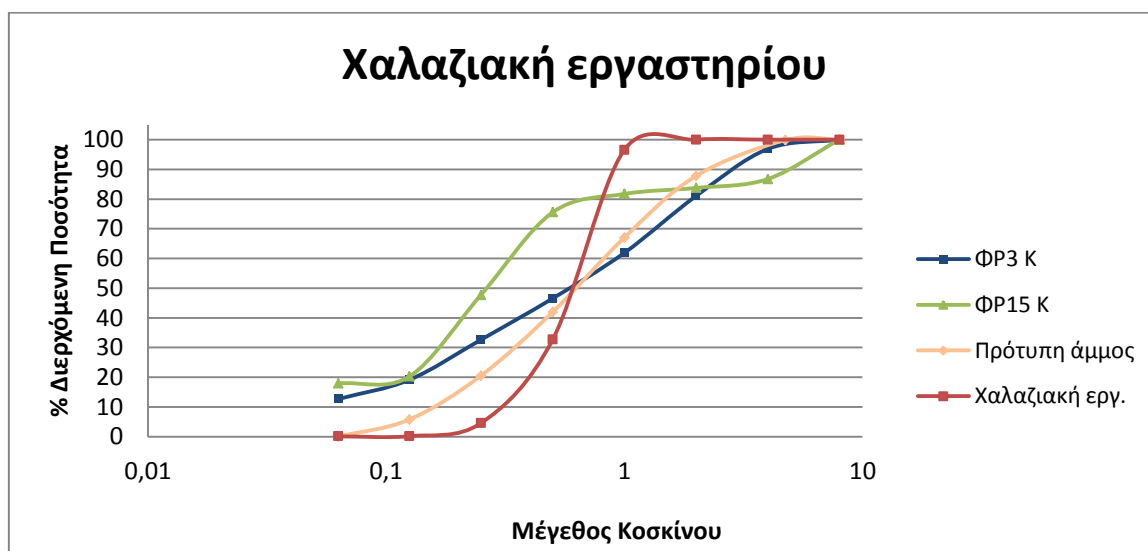
Σχήμα 142: Καμπύλη κοκκομετρικής διαβάθμισης της χαλαζιακής άμμου του εργαστηρίου σε παραλληλισμό με τα αναλυθέντα δείγματα και την πρότυπη άμμο.
