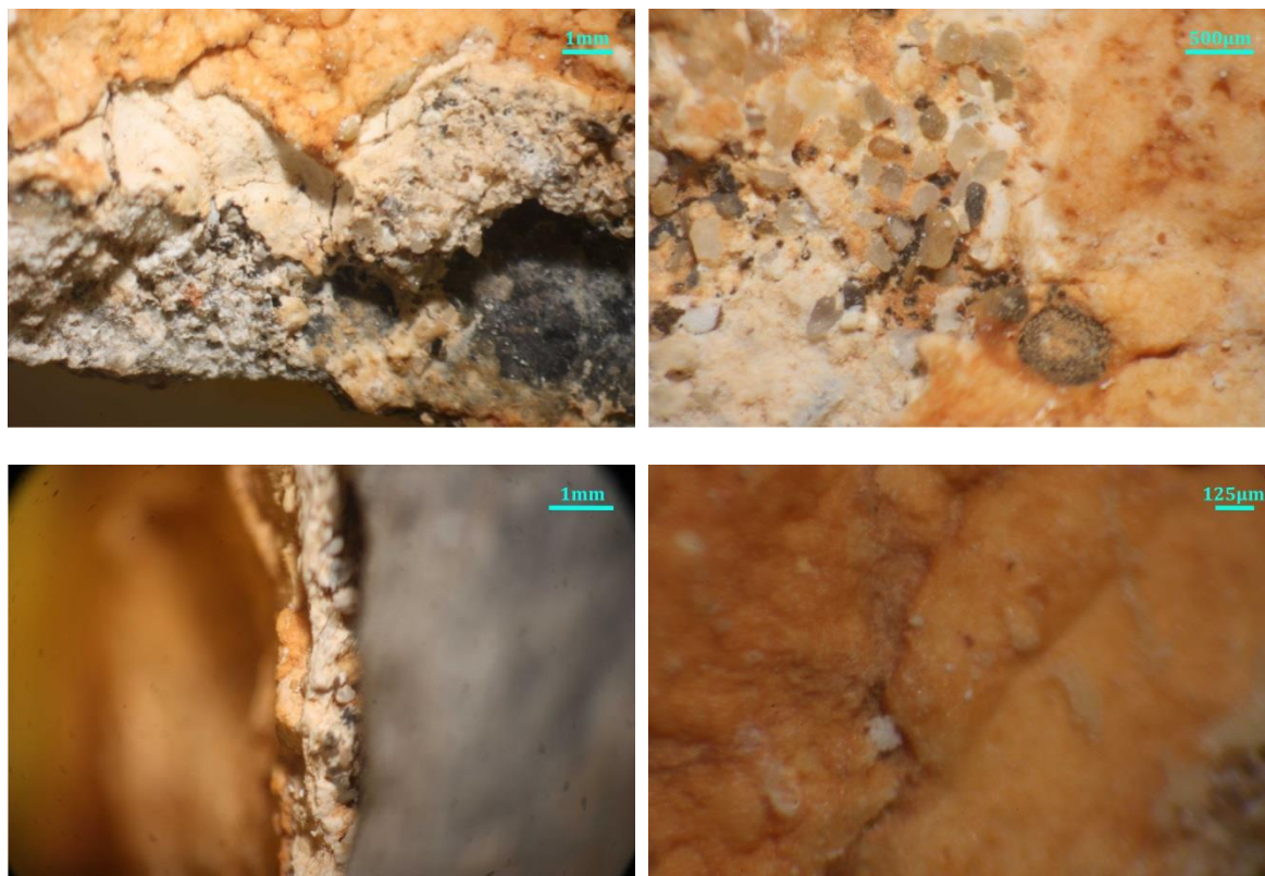
Σχήμα 92: Φωτογραφίες τομών του επιχρίσματος ΦΡ8Ε από οπτικό μικροσκόπιο. Η δομή παρουσιάζει τρεις στρώσεις συνολικά, ενώ η επίστρωση ώχρας έχει ορισμένο πάχος, σε αντίθεση με το ΦΡ7Ε.
