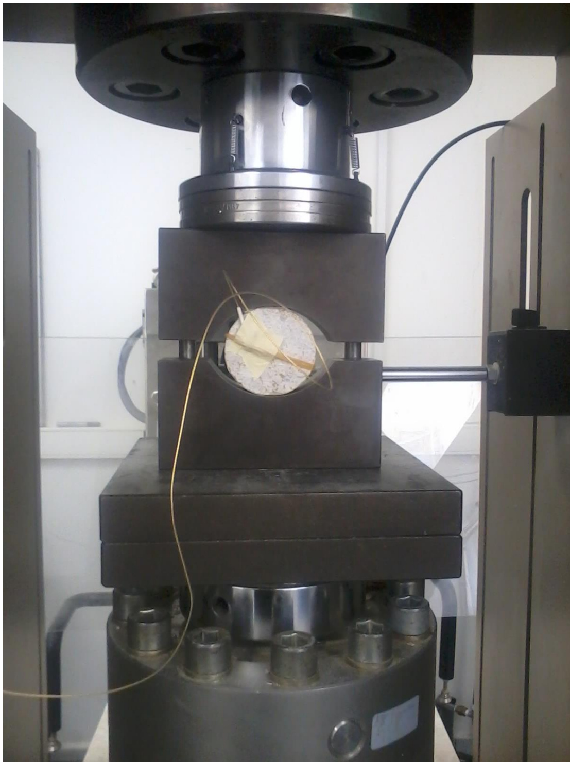
Σχήμα 2.16: Δοκίμιο λίγο πριν την πραγματοποίηση της δοκιμής Brazil. Διακρίνονται οι σιαγόνες φόρτισης.
