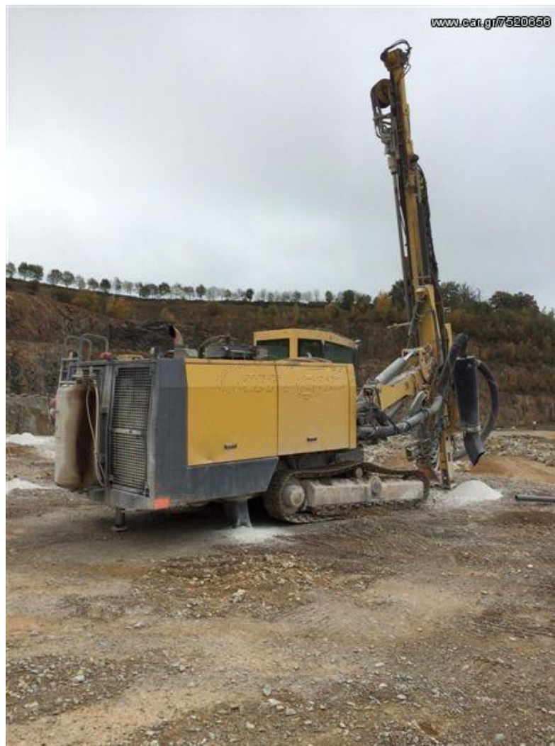
Εικόνα 5.1: Το διατρητικό wagon drill τύπου Atlas Copco L6 down the hole.
