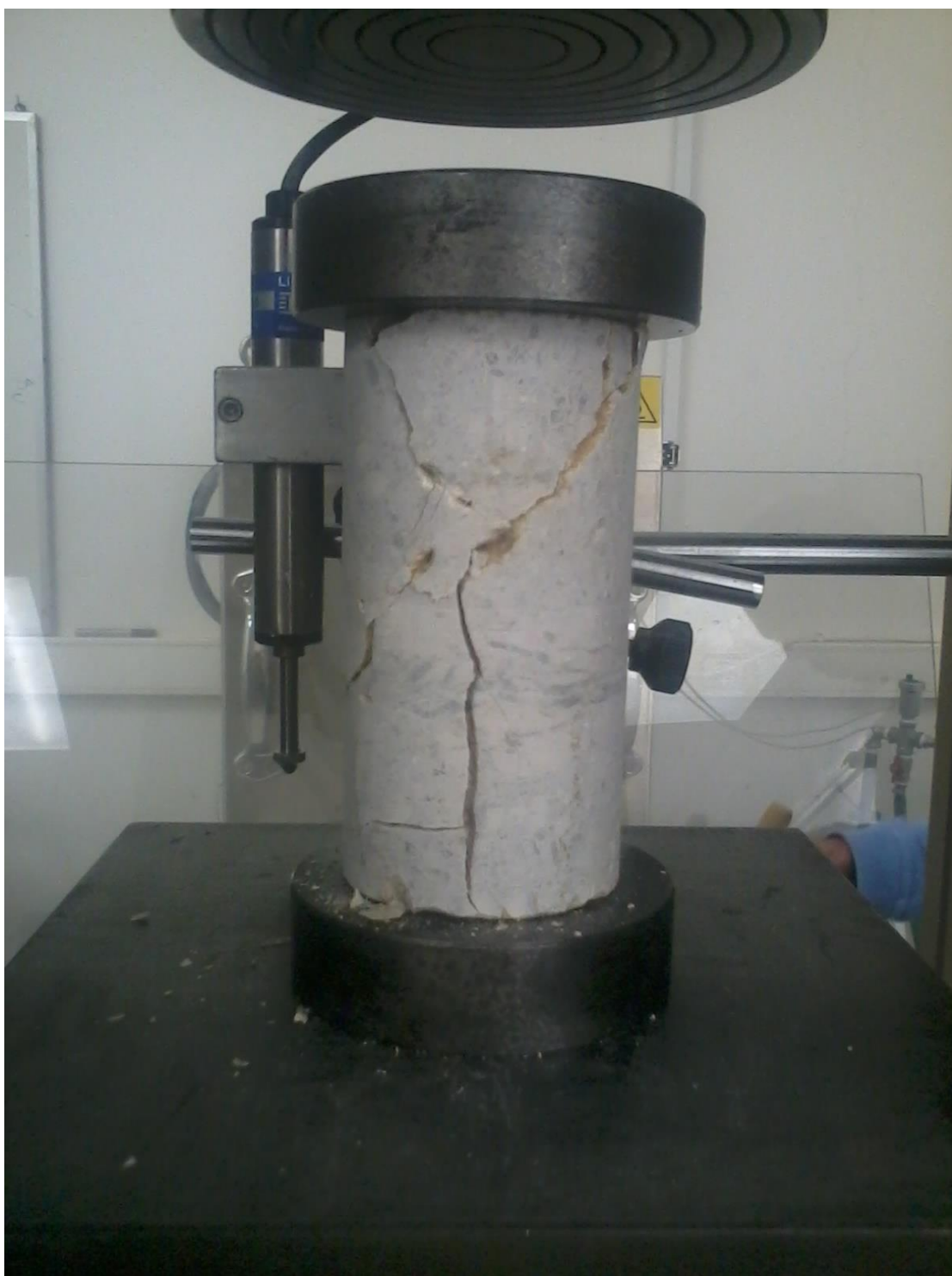
Σχήμα 2.8: Δοκίμιο μετά την πραγματοποίηση της μονοαξονικής δοκιμής. Διακρίνονται οι πλάκες φόρτισης.
