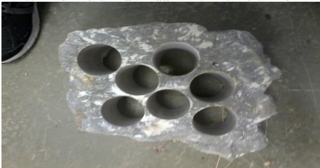
Εικόνα 2.1: Ο όγκος που χρησιμοποιήθηκε για τη κατασκευή των δοκιμίων.
