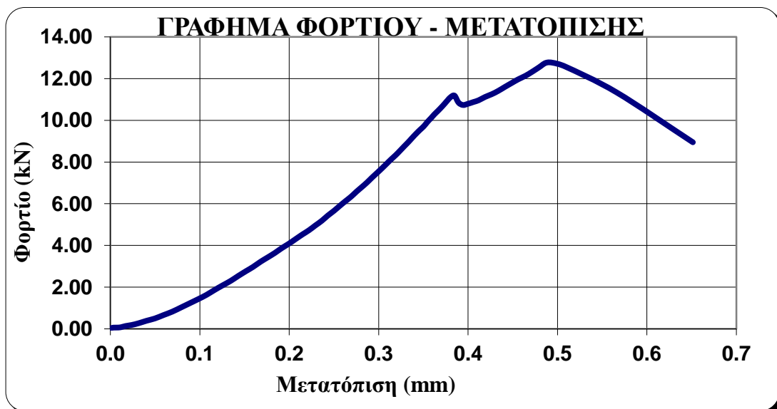
Σχήμα 2.20: Διάγραμμα Φορτίου – Μετατόπισης για το δοκίμιο 4.
