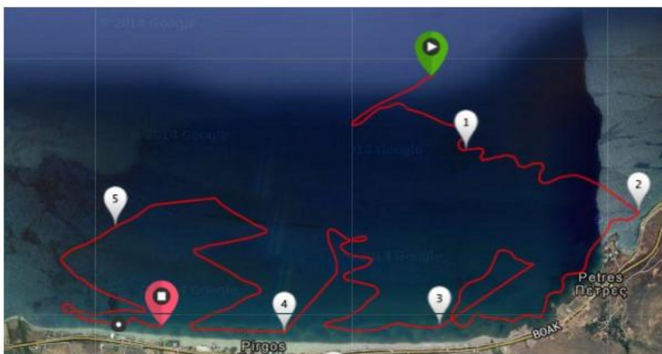
Εικόνα 20: Χωρισμός περιοχής δειγματοληψίας σε υποπεριοχές και ενδεικτική απεικόνιση της διανυόμενης διαδρομής σύρσης.
