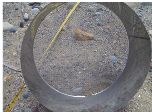
Εικόνα 17: Κόσκινο ανοίγματος 2mm για την πρώτη διαλογή του δείγματος.
