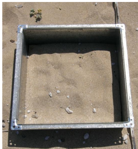
Εικόνα 16: Ειδικά σχεδιασμένο παραλληλεπίπεδο στις διαστάσεις της δειγματοληπτικής μονάδας.
