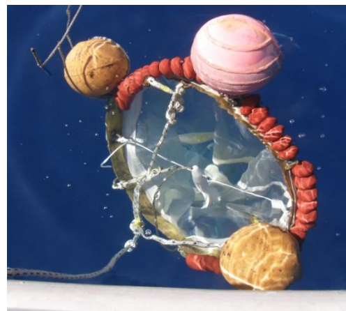
Εικόνα 19: Ο τροποποιημένος δειγματολήπτης WP2 με τις σημαδούρες και το ροόμετρο στη μέση για τον υπολογισμό της διανυθείσας απόστασης.
