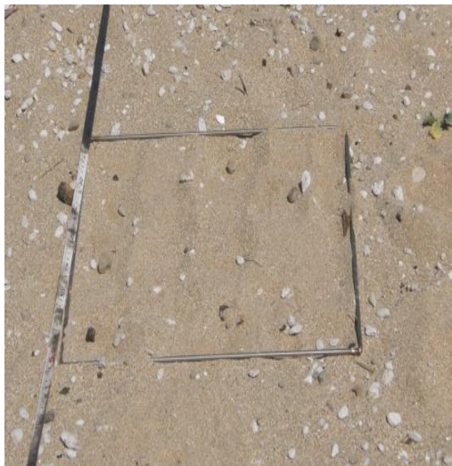
Εικόνα 15: Δειγματοληπτική μονάδα οριοθετημένη από το μεταλλικό πλαίσιο επί της μετροταινίας.
