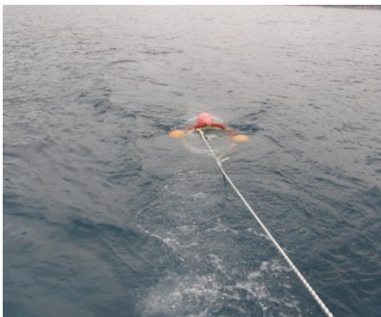
Εικόνα 18: Απεικόνιση της χρήσης του δειγματολήπτης WP2, ο οποίος συρόταν σε απόσταση 50m από το σκάφος.
