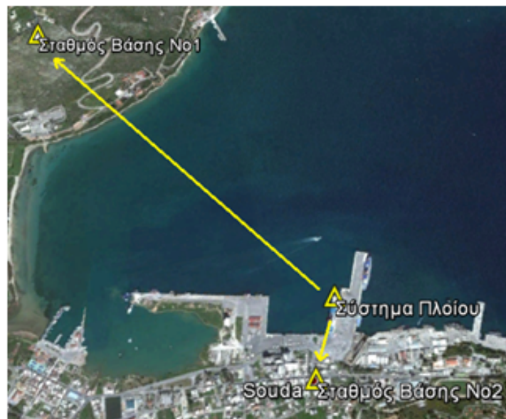
Εικόνα. 5.8: Διάταξη των κεραιών κατά τις δοκιμές στο πλοίο.
