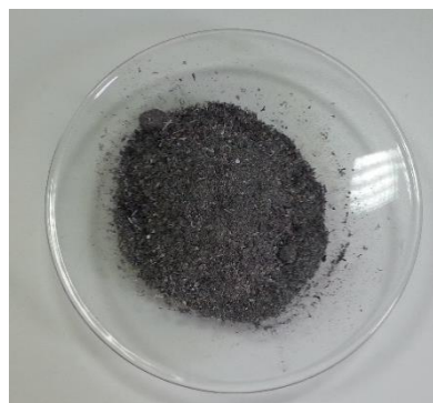
Εικόνα 14: Δείγματα κονιορτοποιημένα με κοκκομετρία πάνω από 0,5mm (α) και το τελικό ομογενοποιημένο δείγμα με κοκκομετρία κάτω από 0,5mm (β).
