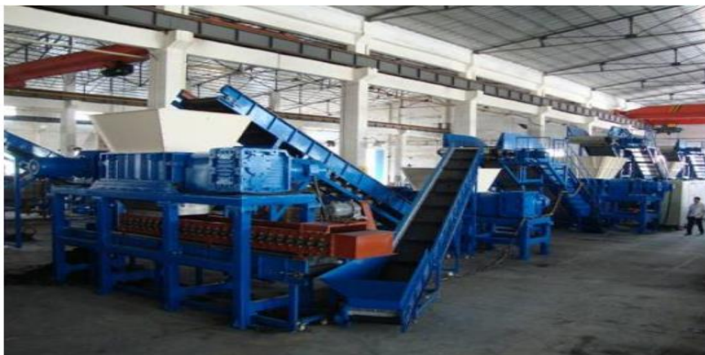
Εικόνα 10 : Μηχανισμός τεμαχισμού στο χώρο της γραμμής παραγωγής
