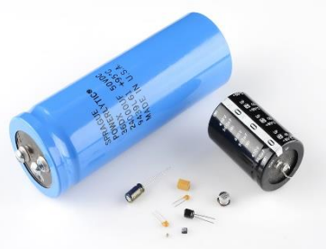
Εικόνα 6: Πυκνωτές τανταλίου και αλουμινίου
