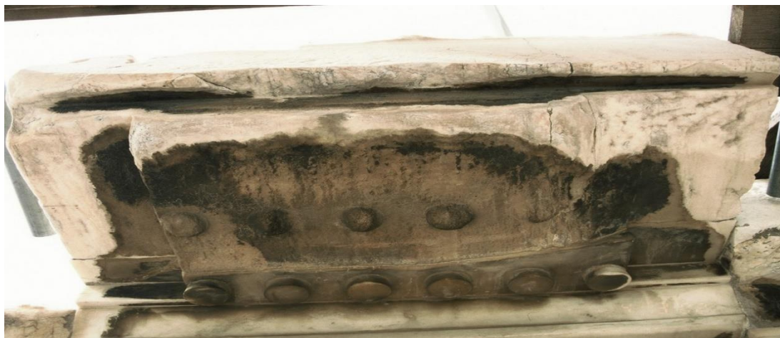
Εικόνα 24: Φθορά μαρμάρου μετά από γυψοποίηση
