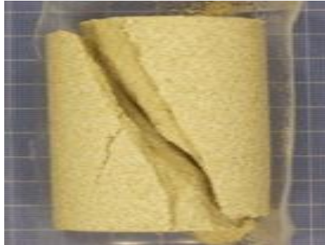
Εικόνα 30: Φωτογραφία του θραυσμένου δοκιμίου ψαμμίτη Castlegate σε ανεμπόδιση θλίψη σε ξηρές συνθήκες.
