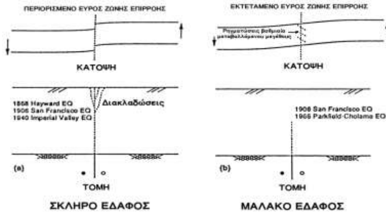
Σχήμα 5.2. Διάδοση διάρρηξης ρήγματος οριζόντιας μετακίνησης σε υπερκείμενους εδαφικούς σχηματισμούς (Bray et al., 1994c).
