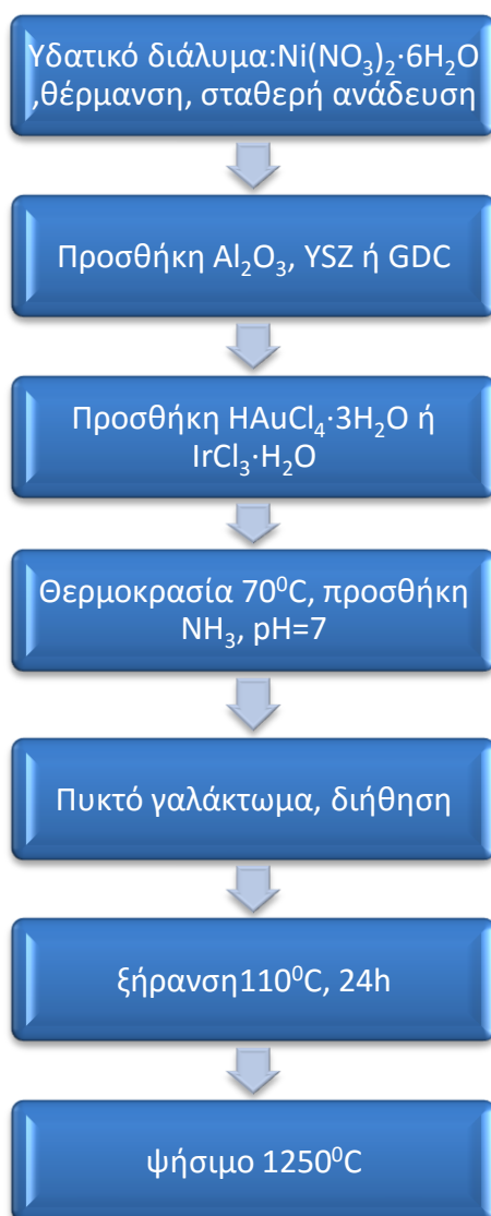
Σχήμα 2.1: Στάδια παρασκευής καταλυτών με τη μέθοδο του υγρού εμποτισμού.
