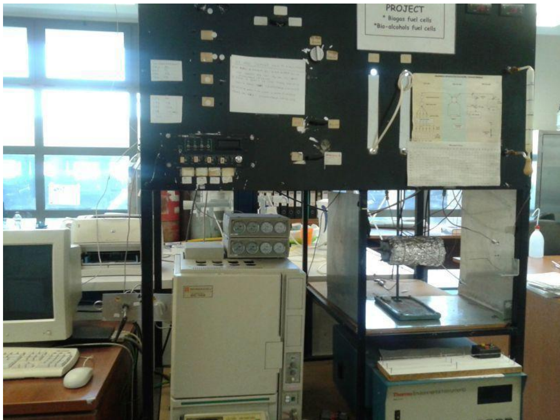
Σχήμα 2.6: Φωτογραφία της πειραματικής διάταξης της εσωτερικής ξηρής αναμόρφωσης του CH 4
