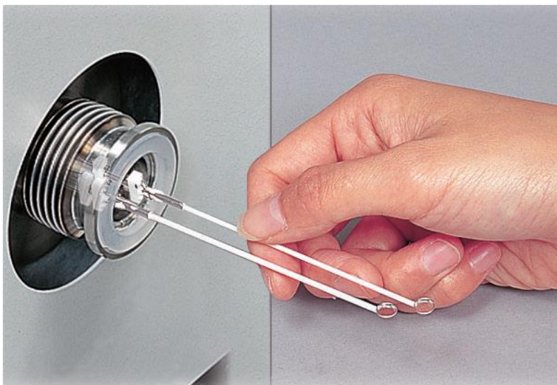
Σχήμα 3.13: Τα θερμοζεύγη του αναλυτή Diamond TG/DTA, Perkin Elmer.
