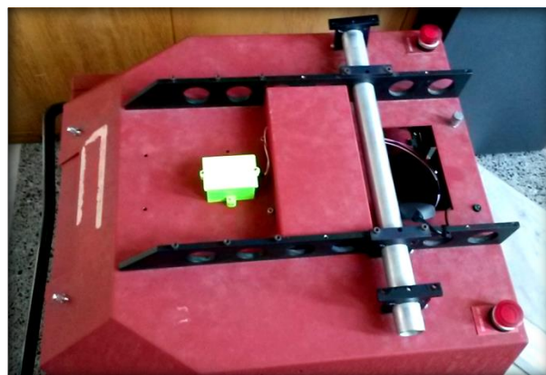
Εικόνα 4.19 Η τελική τοποθέτηση της πυξίδας πάνω στο καπάκι του ρομποτικού οχήματος
