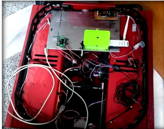
Εικόνα 4.18 Η τελική τοποθέτηση της βάσης με τα ηλεκτρονικά εξαρτήματα στο εσωτερικό του ρομποτικού οχήματος
