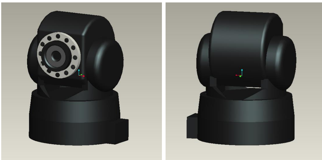
Εικόνα 3.26 Η σχεδίαση της στερεοσκοπικής κάμερας, μπροστά και πίσω όψη και με χαρακτηριστικά: Μήκος 91 mm, Πλάτος 103 mm, Ύψος 135 mm
