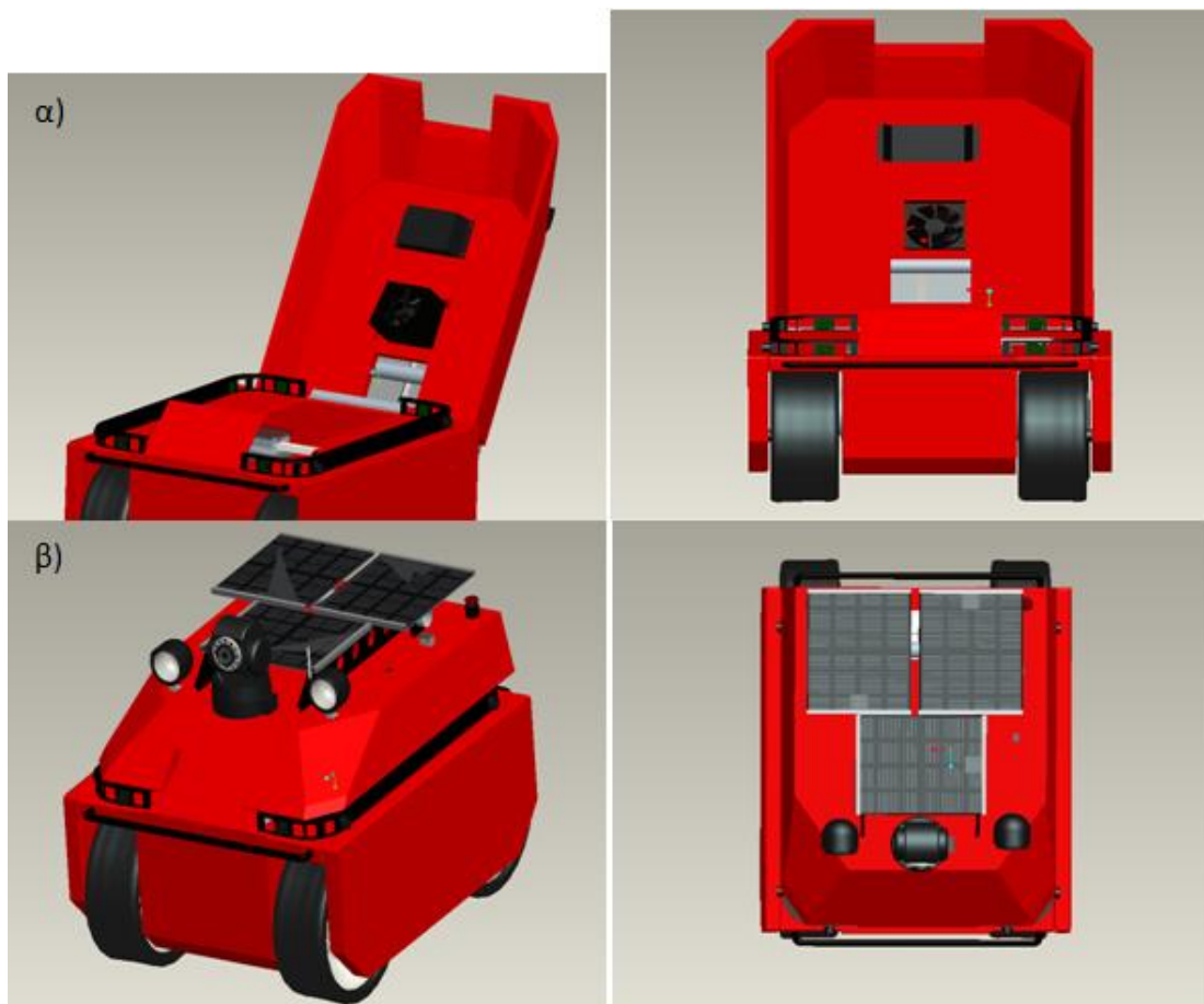
Εικόνα 3.38 α) Η πλάγια όψη και η πρόσοψη του εσωτερικού του οχήματος με τον ρυθμιστή φόρτισης συναρμολογημένο κάτω από το καπάκι, β) Η κάτωψη και η πλάγια όψη του ρομποτικού οχήματος έπειτα από την συναρμολόγηση των τριών φωτοβολταϊκών πάνελ
