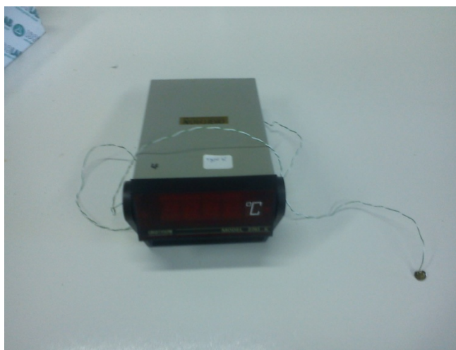
Εικόνα 3.23. Θερμοζεύγος type K που χρησιμοποιήθηκε στο εργαστήριο
