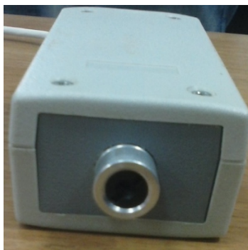
Εικόνα 3.18. Ίδιο- κατασκευή για την τοποθέτηση του UV-led driver
