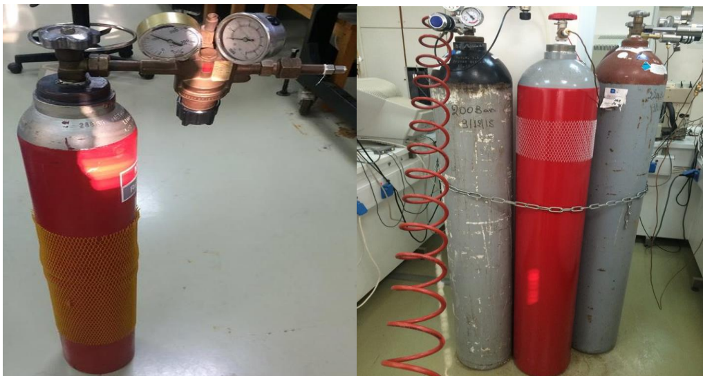
ΕΙΚΟΝΕΣ 3.8 , 3.9: Αριστερά η φιάλη μεθανίου με το ενσωματωμένο μανοεκτονωτή και δεξιά φιάλη διοξειδίου του άνθρακα (κόκκινο χρώμα ).
