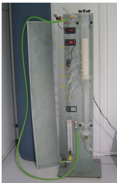
Εικόνα 3.3.1: Πειραματική διάταξη προσομοίωσης αντιδραστήρα ρευστοποιημένης κλίνης
