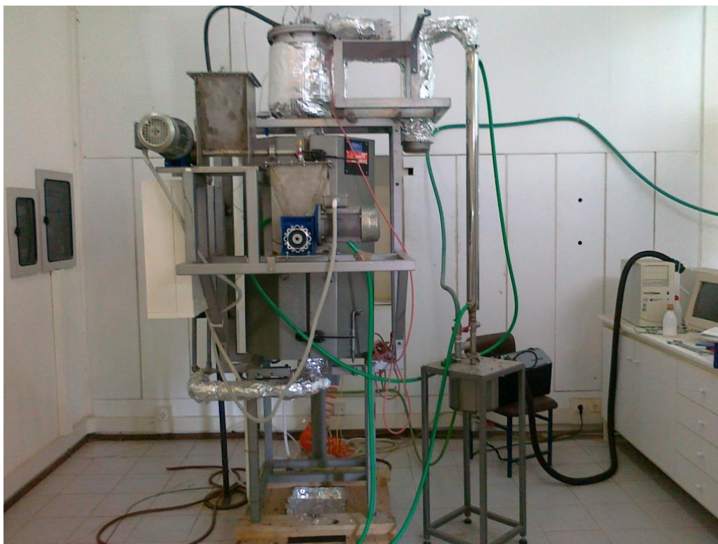
Εικόνα 3.2.1: Πειραματικός αντιδραστήρας ρευστοποιημένης κλίνης
