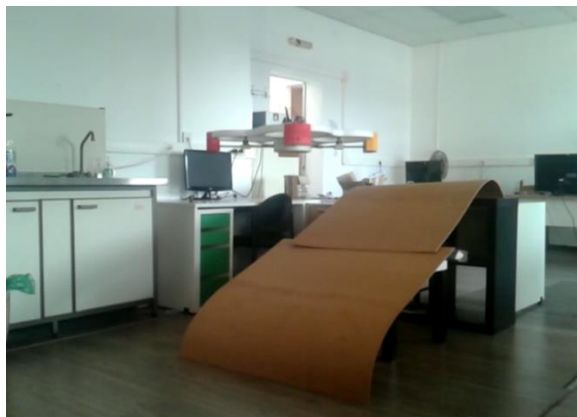
Σχήμα 5.1 Μια ράμπα εμφανίζεται στο κάτω μέρος του πολυκοπτέρου τη στιγμή που βρίσκεται σε alt hold και κινείται προς τα εμπρός. Το πολυκόπτερο μεταβάλλει το ύψος του ακολουθώντας τη γεωμορφολογία του εδάφους.
