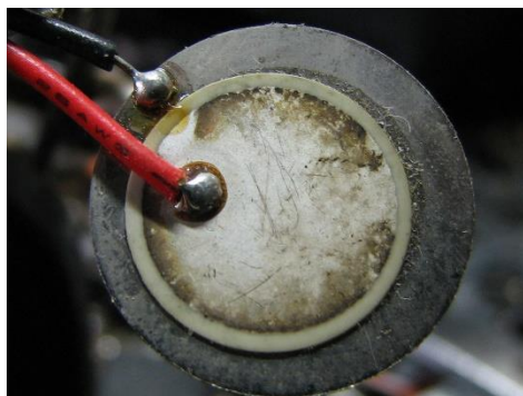
Εικόνα 4-Χρήση πιεζοηλεκτρικού υλικού σε συσκευή ηχητικής σήμανσης
