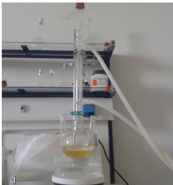
Εικόνα 1 : Πειραματική διάταξη εργαστηριακής παραγωγής βιοντίζελ από έλαιο άλγης
